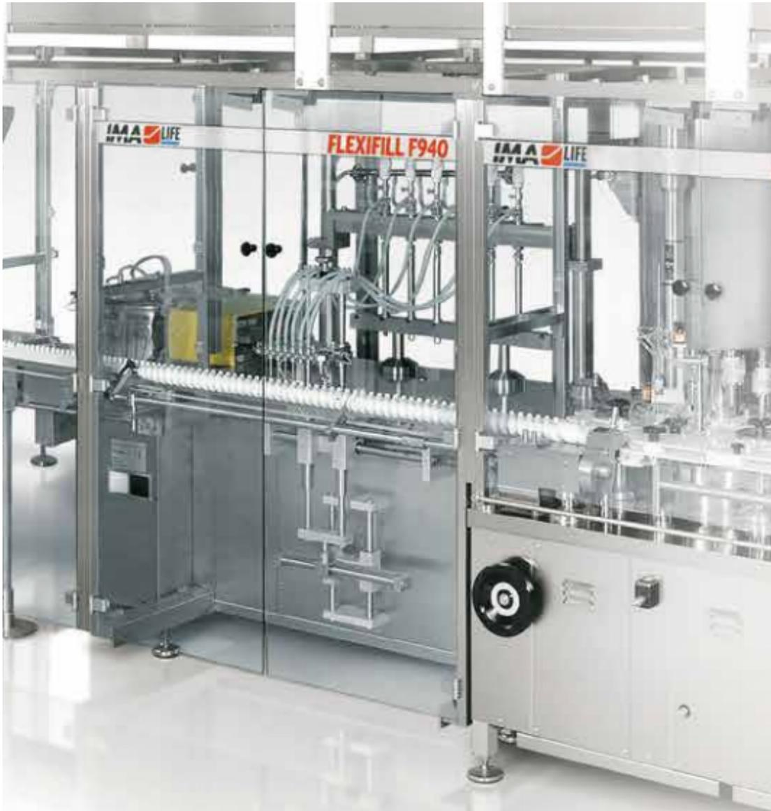
Figura 2.6.18 Llenadora y tapadora IMA modelo F940
