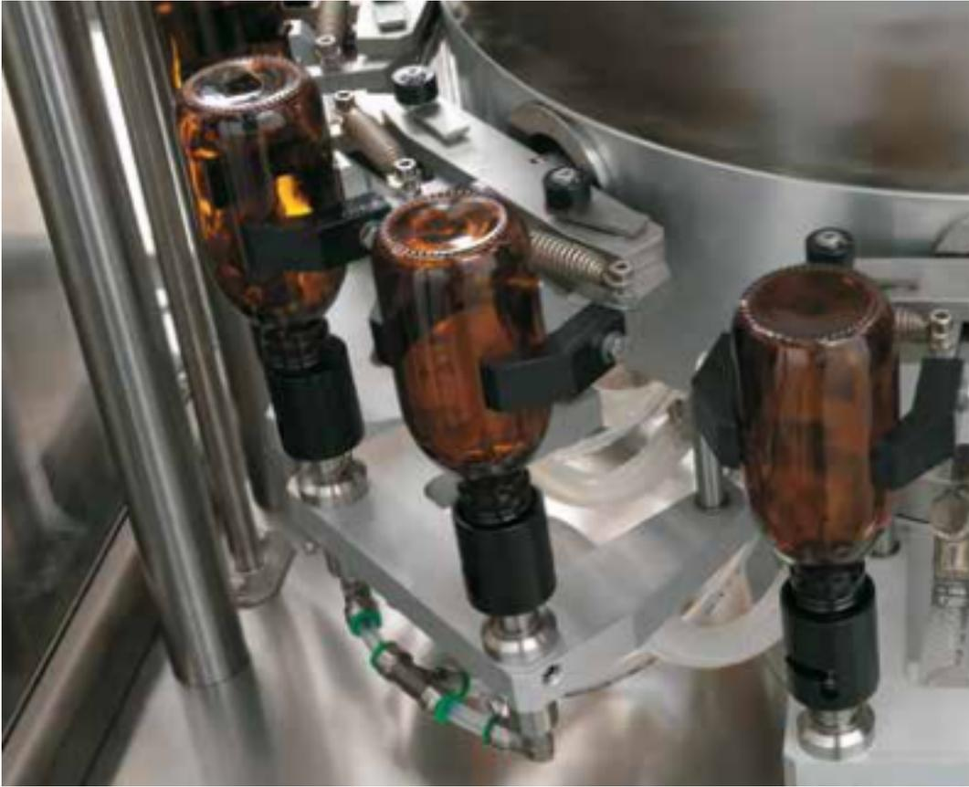
Figura 2.6.17 Sopladora de frascos IMA modelo Y16 - Foto 2
