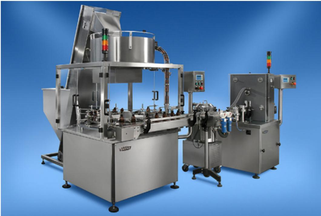
Figura 2.6.9 Estación de alimentación y soplado de envases Tover - Foto 1
