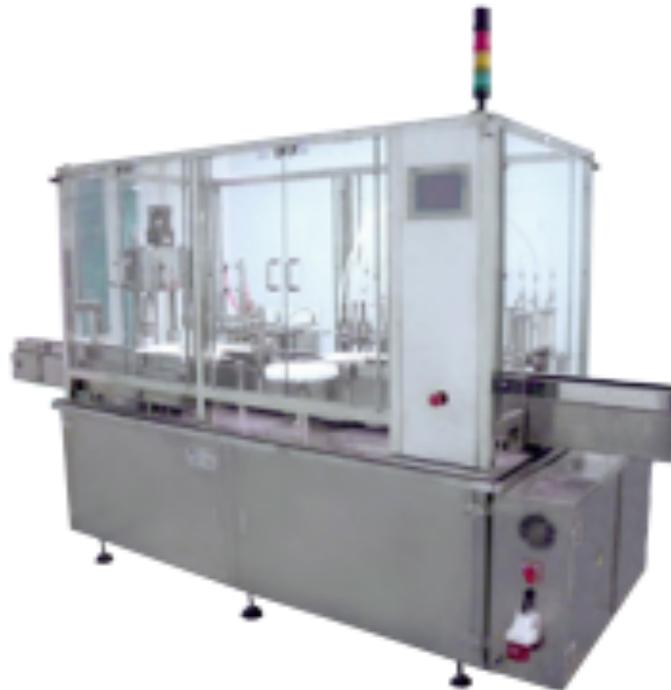
Figura 2.6.3 Monobloque de llenado y roscado Cima adaptación del modelo SSL10
