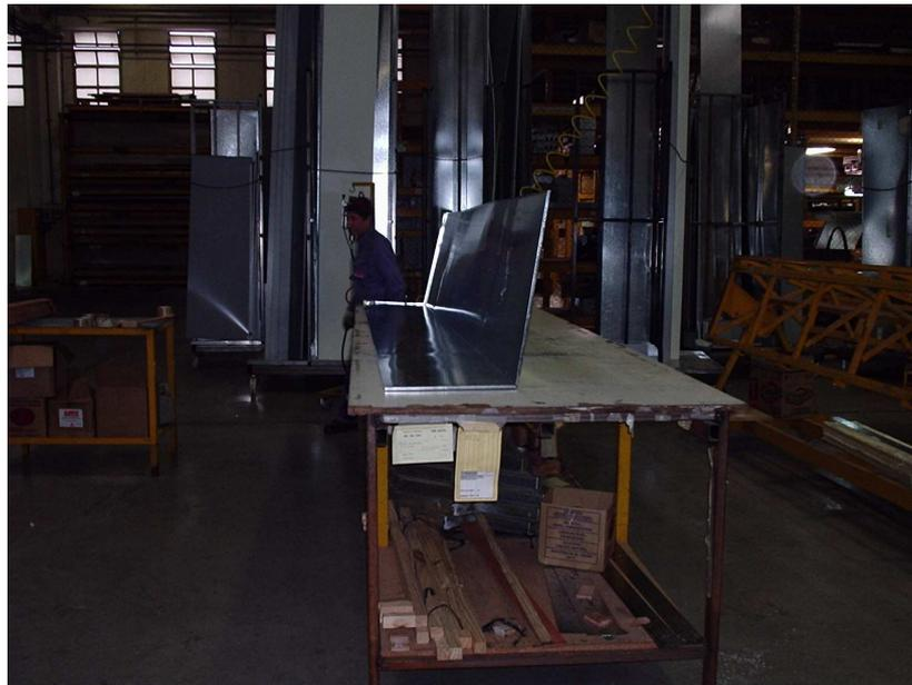
Figura 2.5. Chapa delantera del cuerpo de una exhibidora colocada sobre una de las dos mesas de trabajo.
