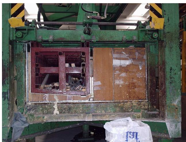
Figura 4.17. Prensa grande con su “macho” y sus contramoldes.
