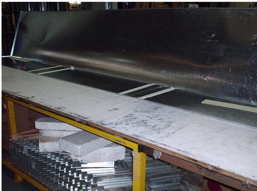
Figura 2.6. Refuerzos colocados en una de las chapas de una exhibidora.
