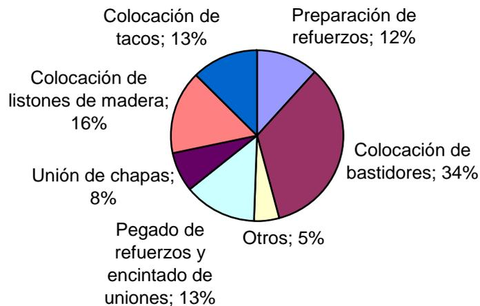
Figura 4.1. Distribución de los tiempos de armado del piso de un modelo Manila 90 X 3750.
