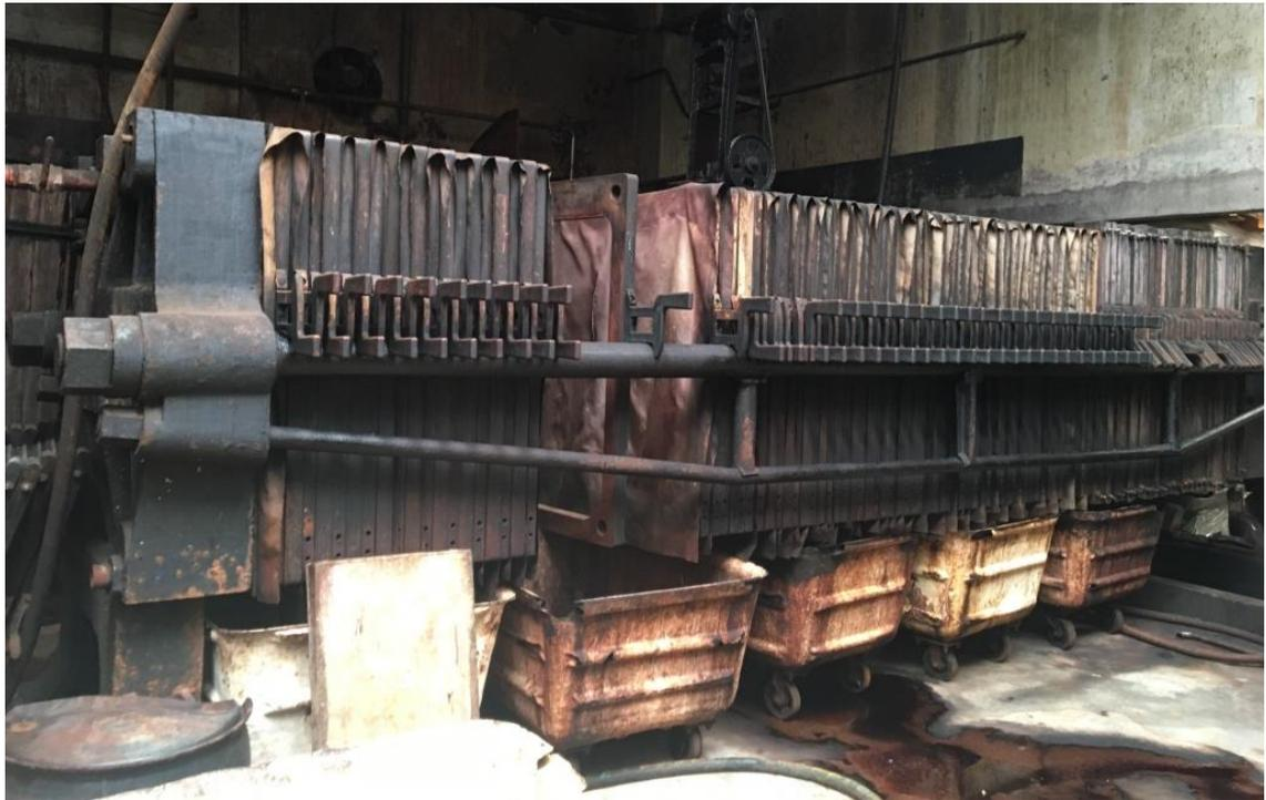
Figura 6.3. Fotografía de los filtros prensa.
