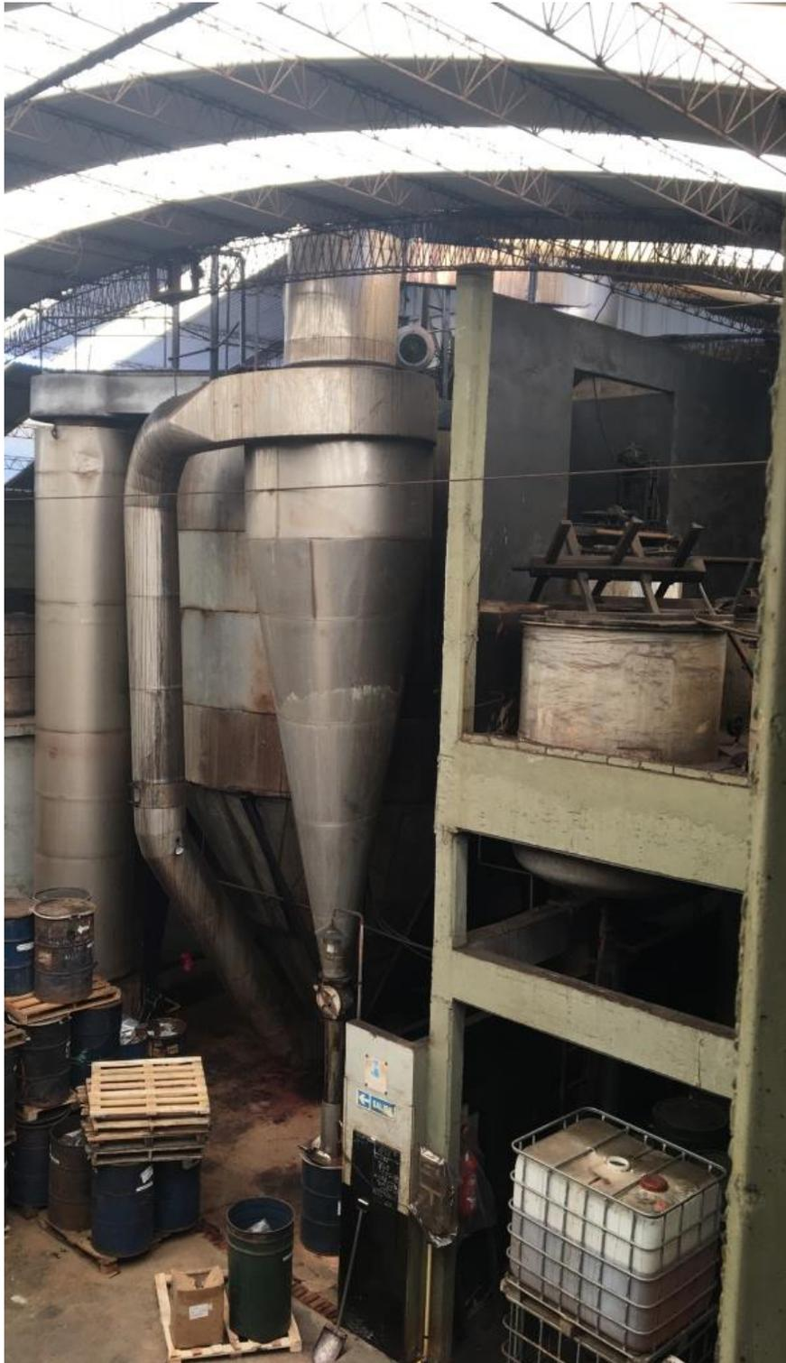
Figura 6.4. Fotografía de uno de los secadores Spray visto desde el piso superior.
