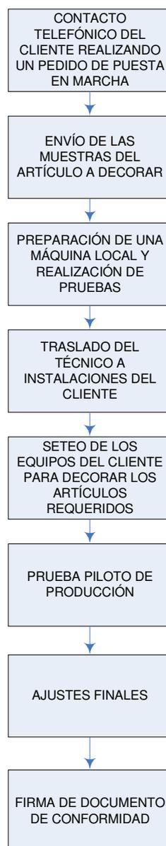
Figura 3.1. Procedimiento para la realización del servicio de puesta en marcha.
