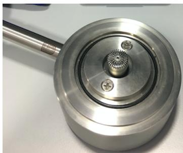
**Figura 7.24:** Micrófono 377C13 contenido en la base del simulador de oído AEC201-A.
