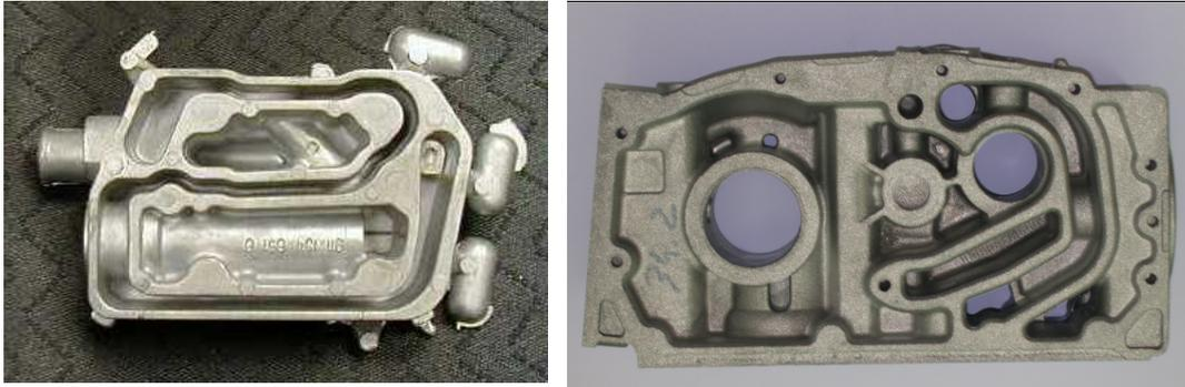
**Figura 15.5.** Componentes conformados por procesos SSR (gentileza Idra Casting Machines)
