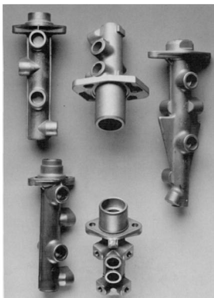
**Figura 14.8** Cilindros maestros de freno conformados por thixoforging a partir de una aleación de aluminio A357.
