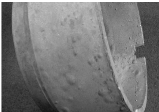
**Figura 2.14.** producción del fenómeno de "blistering" en un componente conformado por fundición por inyección como resultado de un tratamiento térmico
