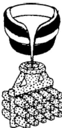
**Figura 2.13 (e).** El metal fundido es vertido directamente en el molde caliente
