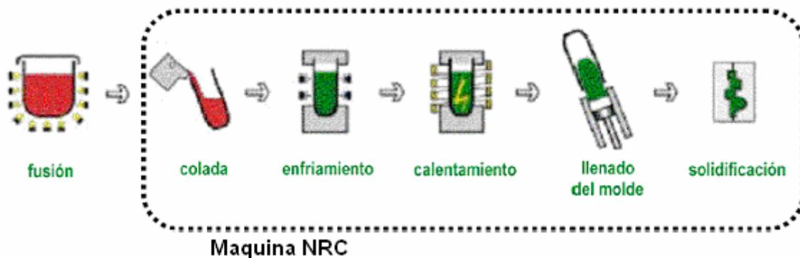
**Figura 7.12.** Etapas del proceso de New Rheocasting
