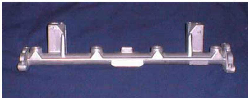
**Figura 14.15.** Conducto común de inyección producido por la empresa Gibbs Die Casting con éxito desde el año 2000.
