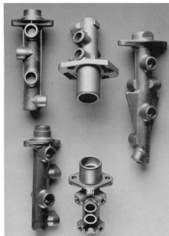
Figura 15.3. Cilindros maestros de freno
