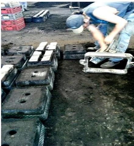
Cuando ya se encuentra listo el molde se retira la caja molde y se forman hileras para optimización del proceso al momento de colar el metal en estado líquido.
