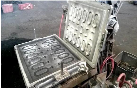
Para garantizar la resistencia del molde se emplea una prensadora semi automática la cual emplea aire de alta presión permitiendo compactar la arena del molde.
