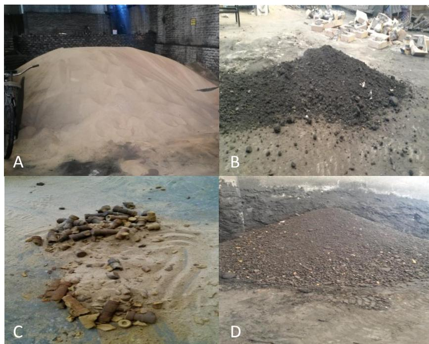
**Figura 2.** Tipos de arenas muestreadas: **A.** Arena revestida empleada para la fabricación de noyos, **B.** Arena de moldeo, **C.** Residuos de noyos empleados en la fundición, **D.** arenas de fundición descartadas.
