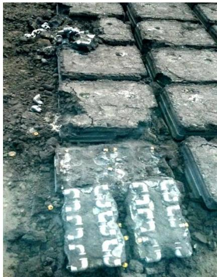
**Figura 12.** Proceso de desmolde de piezas.
