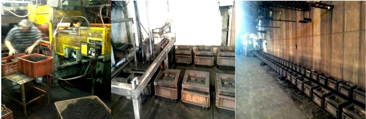
**Figura 8.** Proceso de carga de arena de contacto al equipo de moldeo automático.
