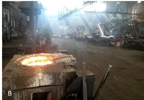
**Figura 10B.** Crisol empleado para mantener la temperatura del material fundido.
