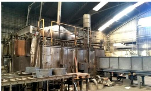
**Figura 14C.** Recocido para fundición maleable.
