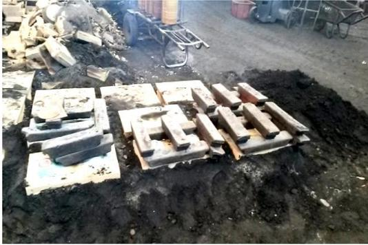
Finalmente, se recubren con arena de relleno y se pone en la parte superior del molde un contrapeso para impedir la pérdida de metal por el levantamiento del molde debido a la presión ejercida por el hierro fundido.
