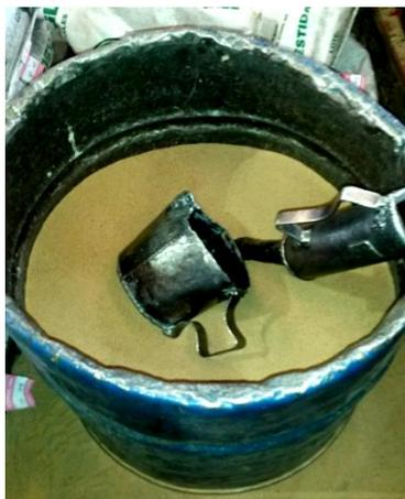
Para la fabricación de los noyos se emplea arena revestida la cual se encuentra compuesta de arena silíceo con una mezcla de resina fenol formol y hexaetilentramina en un 3%.
