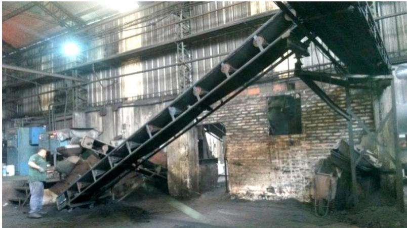
**Figura 19.** Proceso de desterronado y transporte de arena por bandas.
