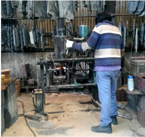
El proceso de fabricación de noyos se realiza mediante el sistema Shell Moulding (SHL) el cual está formado por un polímero fenol formaldehído tipo Novolac que se cataliza por temperatura cuando es expuesto junto a la arena a 200°C durante aproximadamente 60 segundos. El equipo utilizado es una noyera neumática la cual calienta la arena con resina a partir de la combustión de gas natural.
