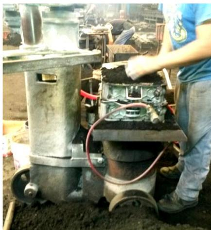
Se completa la caja molde con arena de relleno hasta colmarla e impida algún tipo de fuga del metal en estado líquido.
