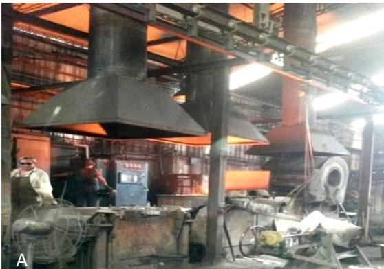
**Figura 10A.** Hornos eléctricos empleados para fundir el metal (Hierro).
