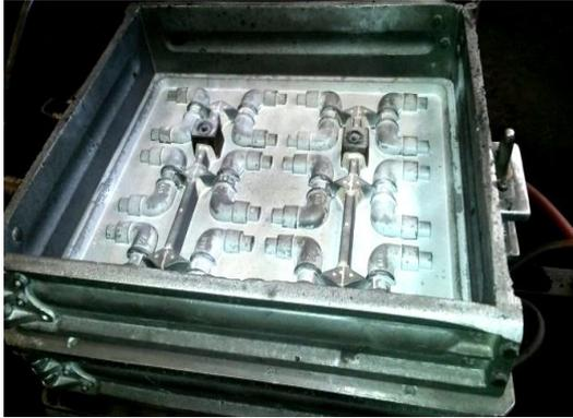
Se coloca una caja metálica-molde sobre la matriz del producto que se requiere fabricar y se aplica una fina capa de polvo separador
