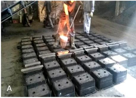
**Figura 11A.** Incorporación de hierro fundido en los moldes.
