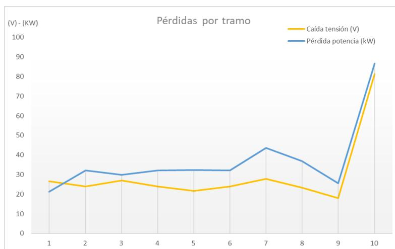
Ilustración 27: caída de tensión y pérdidas de potencia en cada tramo de la instalación eléctrica en un parque eólico más fotovoltaico.
