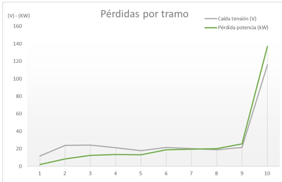
Ilustración 26: caída de tensión y pérdidas de potencia en cada tramo de la instalación eléctrica en un parque eólico.
