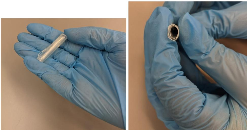
Figura 19: Film enrollado utilizado para ensayo de flexibilidad. Vista frontal y lateral.
