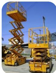
Figura 75. Imagen de ejemplo típico de suministro reutilizable, plataforma de elevación.
