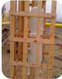
**Figura 69.** Imagen de un tanque de potencia para automatización de 30 plg en su jaula de embalaje.
