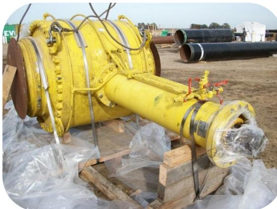
**Figura 55.** Ejemplo de deterioro de embalaje y consecuencias sobre la unidad informadas por obra: pintura dañada, extremos desprotegidos, ralladura de esfera, golpes en los biseles, eje “descolgado” (falta de tope), etc. Actualmente, se pudo constatar que no se realiza gestión alguna sobre los tiempos de permanencia (rotación de inventarios) ni de los costos por tenencia de cada suministro almacenado.
