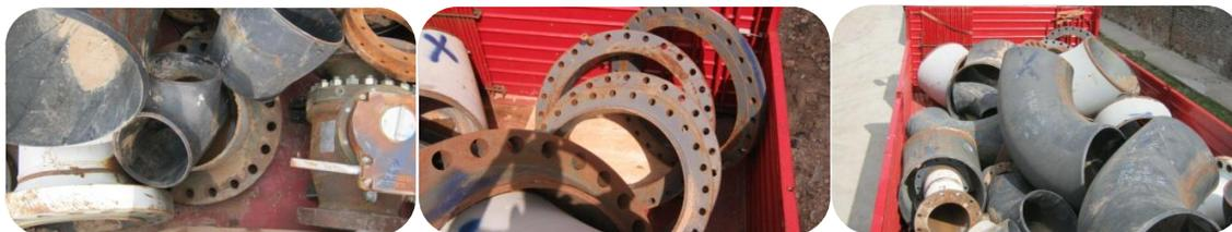
**Figura 56. Imágenes de devolución de obra. Bridas ralladas, accesorios oxidados y soldados, válvulas sin protección, estiba indebida, ninguna identificación ni protección.**
