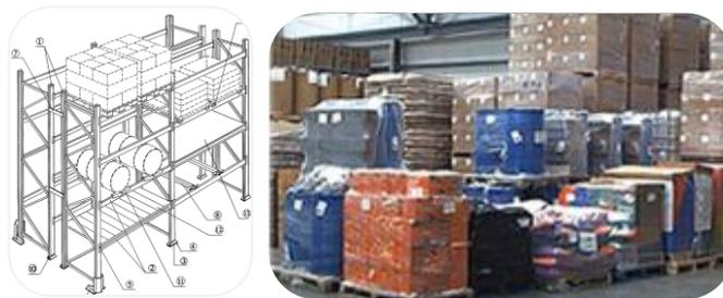
Figura 42. Imágenes de técnicas de almacenamiento Selectivo y en Bloque aplicados.
