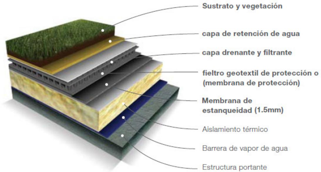
Figura 6.8 Detalle del sistema de techo verde del edificio
