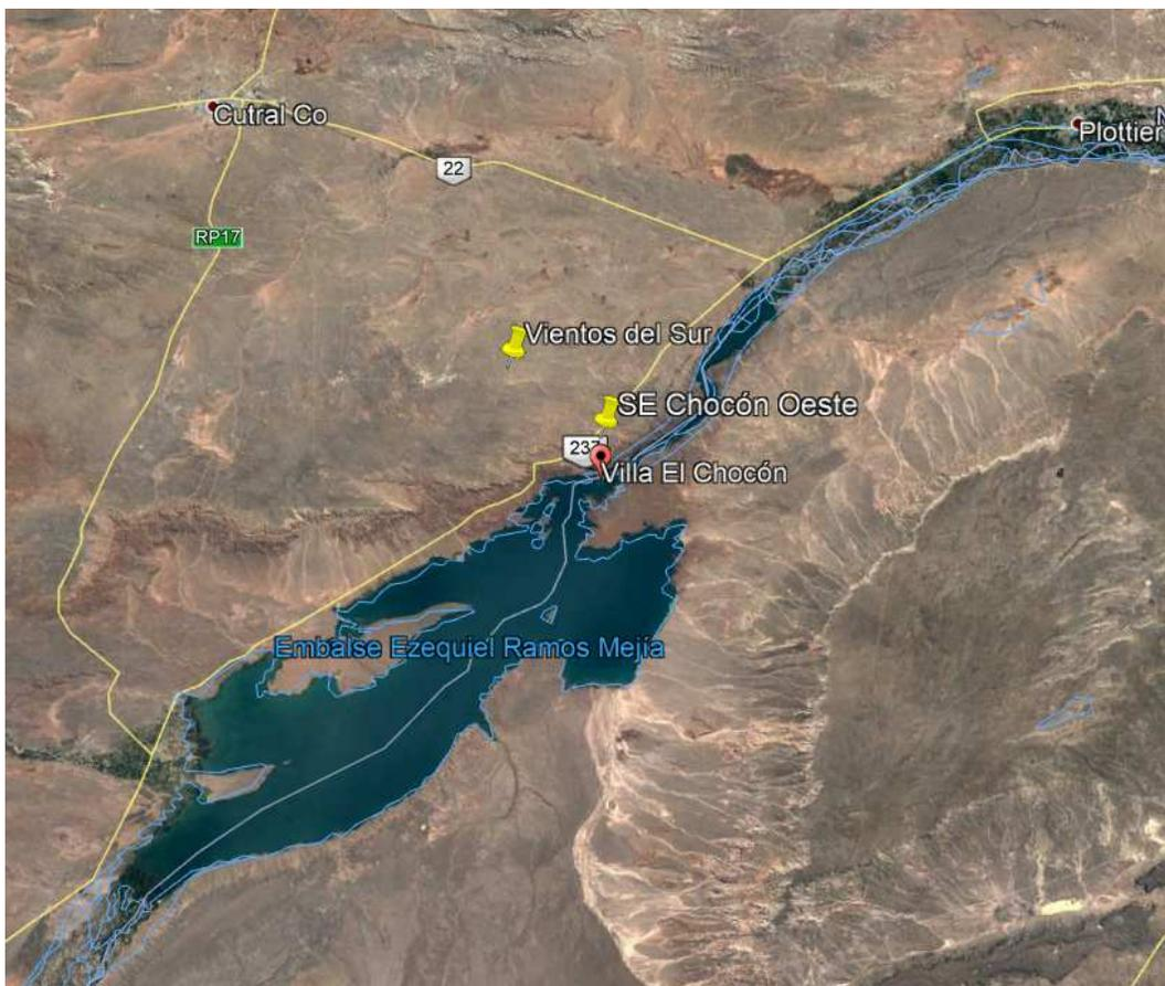
La vinculación del parque eólico con la SE Chocón Oeste se realizará mediante una línea aérea en la tensión de 132 kV en aproximadamente 5 km.
