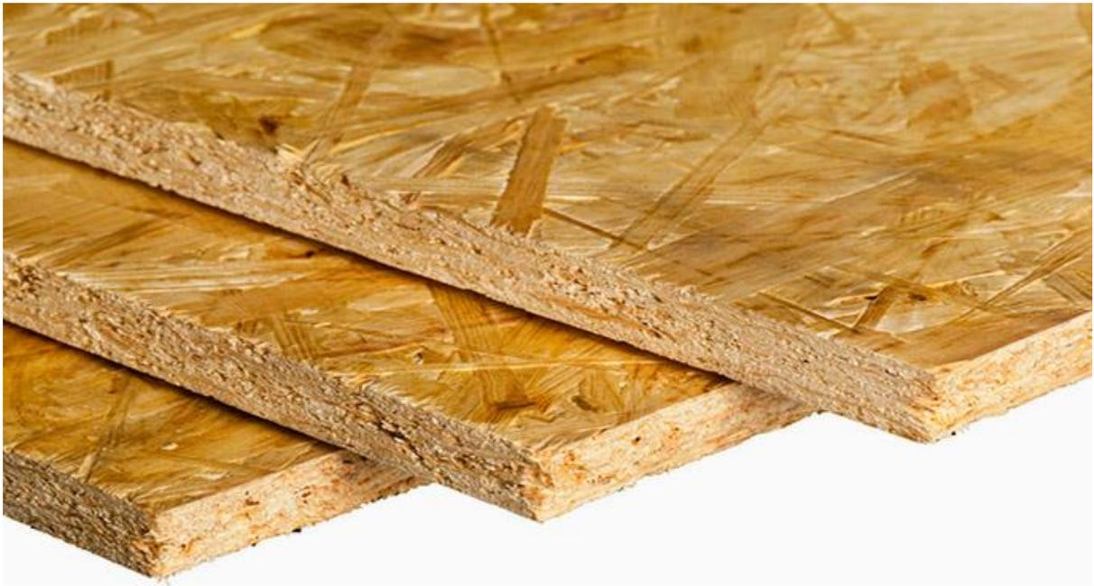
Debido a sus buenas propiedades mecánicas y la orientación de los filamentos dentro de los paneles, OSB es particularmente adecuado para aplicaciones de soporte de carga en la construcción y es ampliamente utilizado para pisos, cubiertas de techos, revestimientos de paredes y mobiliario.
