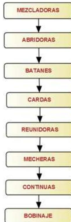
Figura 2.2 Máquinas y procesos de la hilatura de algodón
