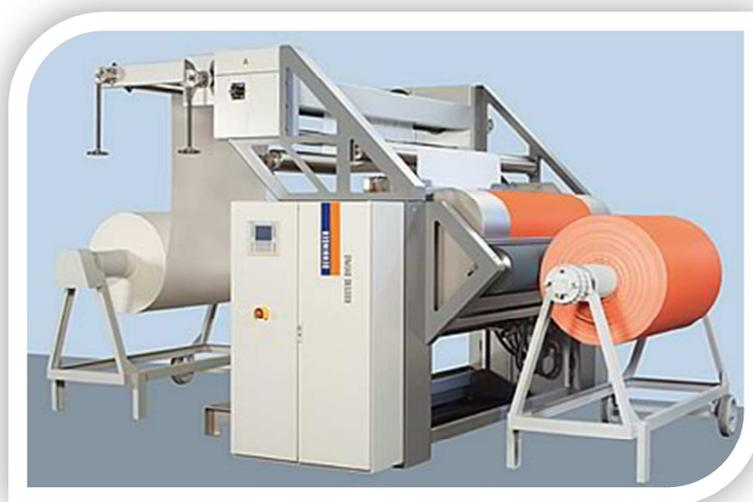
Figura 5.9 Impregnación de tintura en máquina foulard
