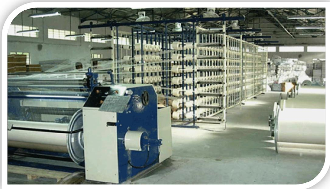
Figura 4.3 Fileta con máquina urdidora directa
