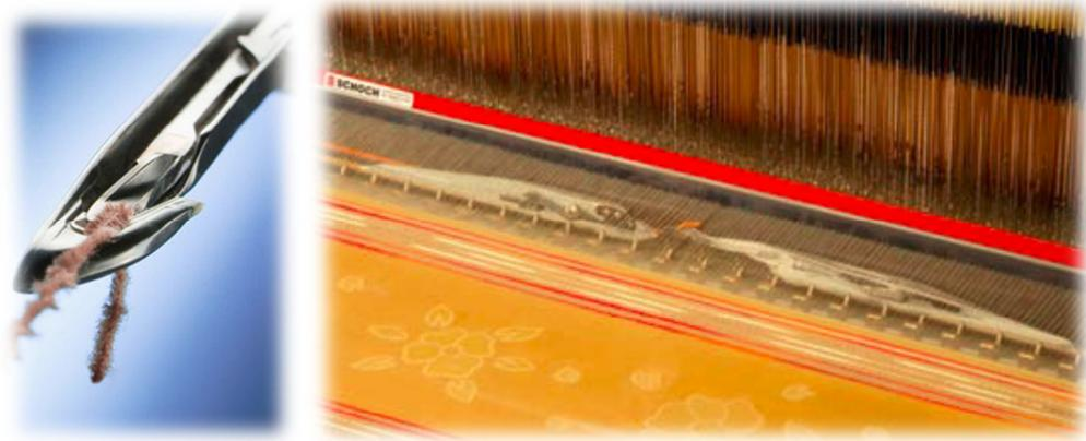
Figura 2.14 Pinza receptora y pinzas en punto de unión
