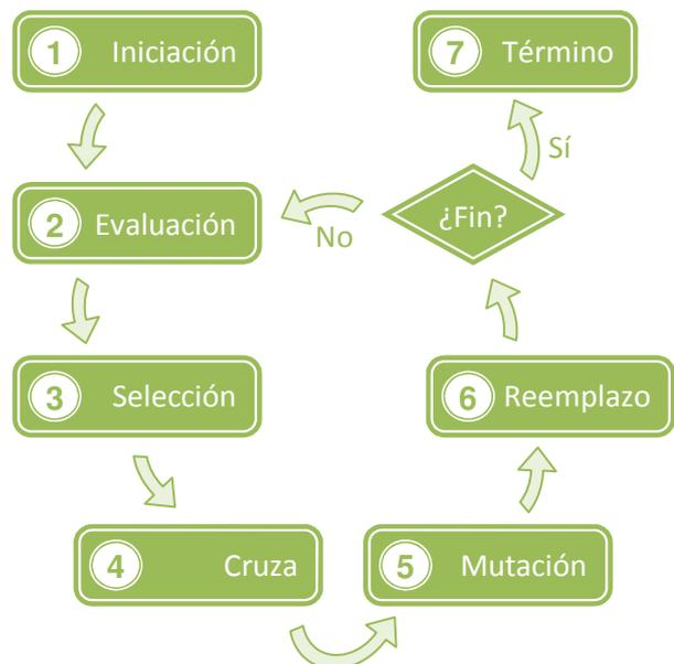
Figura 11 - Diagrama de flujo de un A. G.
