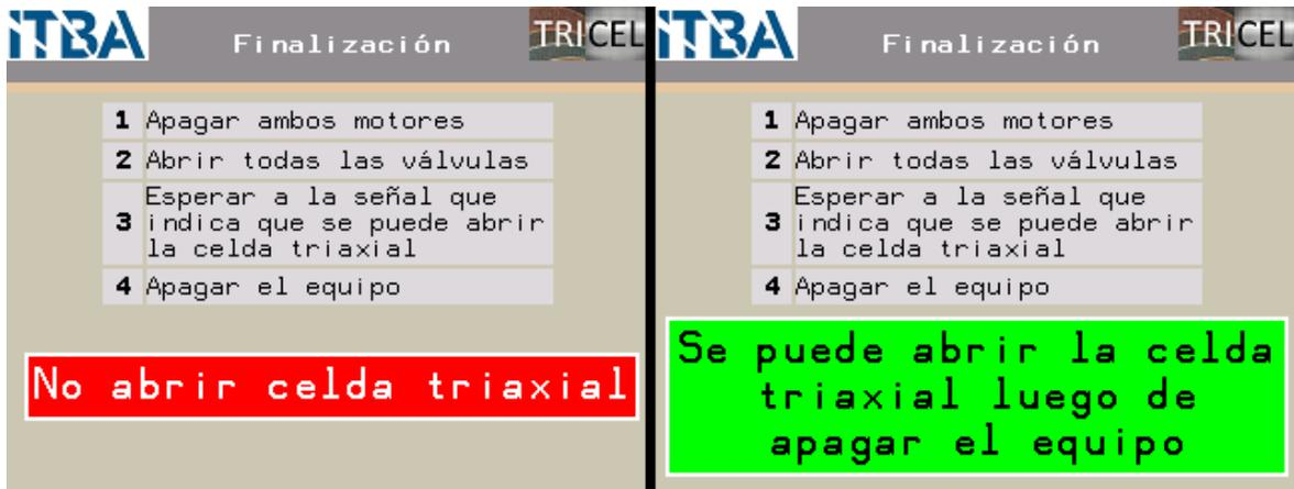
Figura 79. Instrucciones para el apagado del equipo.
