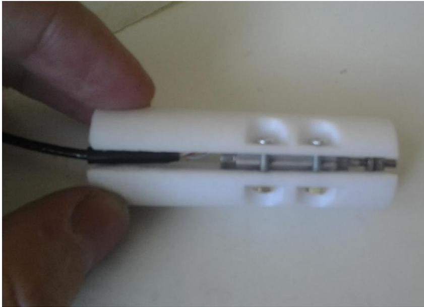
**Figura 26.** Conjunto camisa y LVDT ensamblado.
