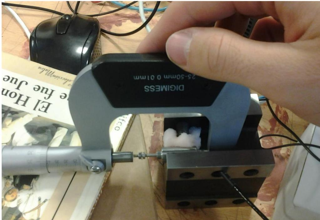
**Figura 33.** Proceso de calibración del LVDT.
