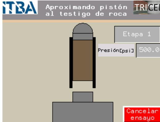
**Figura 74.** Pantalla visible durante la aproximación del pistón a la muestra.
