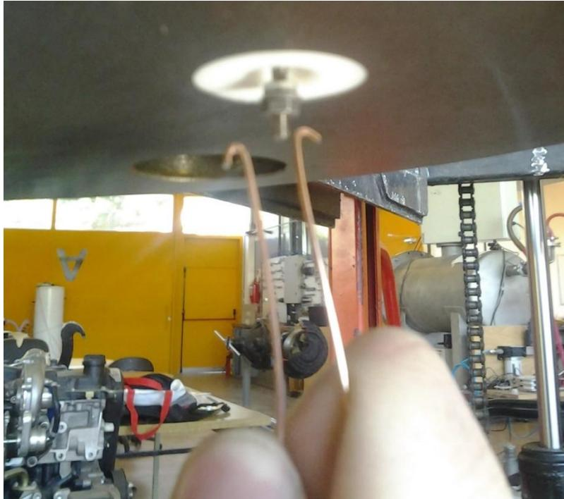
**Figura 30.** Aproximación del alambre para extraer el tapón.
