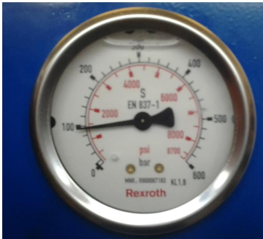
**Figura 51.** Lectura del manómetro cuando el transductor HM20 mide 100 bar.
