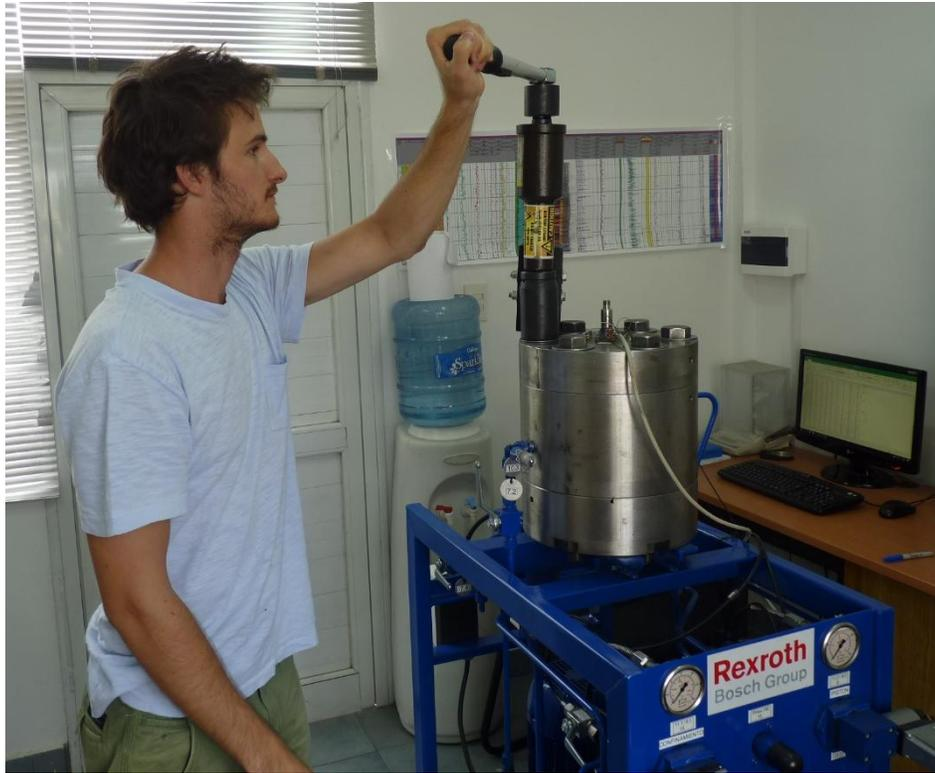
**Figura 106.** Cierre de la celda triaxial.
