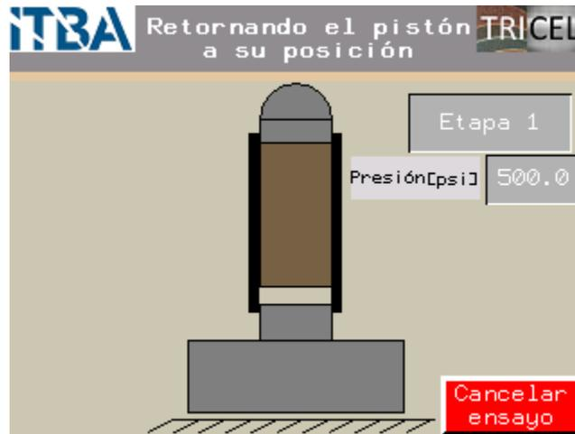
Figura 77. Pantalla visible durante el retorno del pistón al punto muerto inferior.
