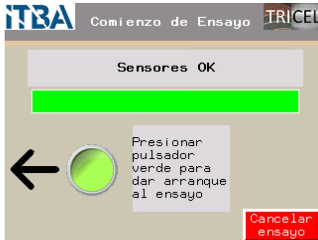
**Figura 72.** Pantalla de evaluación de los sensores antes del inicio del ensayo.
