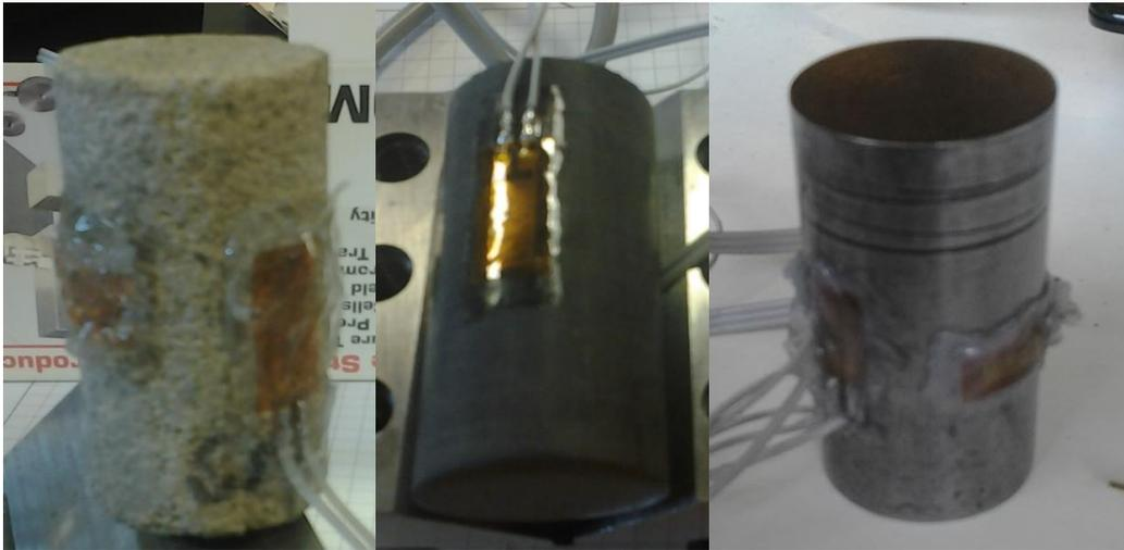
**Figura 104:** Instrumentación con *strain gages* de distintas muestras
