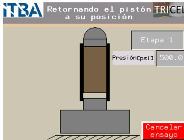
Figura 80. Pantalla visible al presionar la parada de emergencia.
