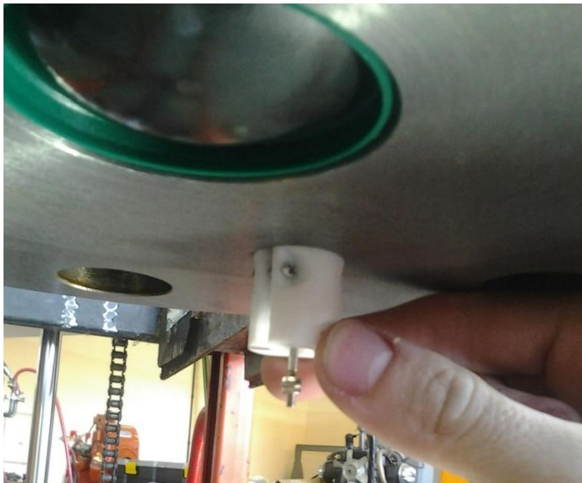
**Figura 27.** Montaje de la camisa y el LVDT en la cavidad.
