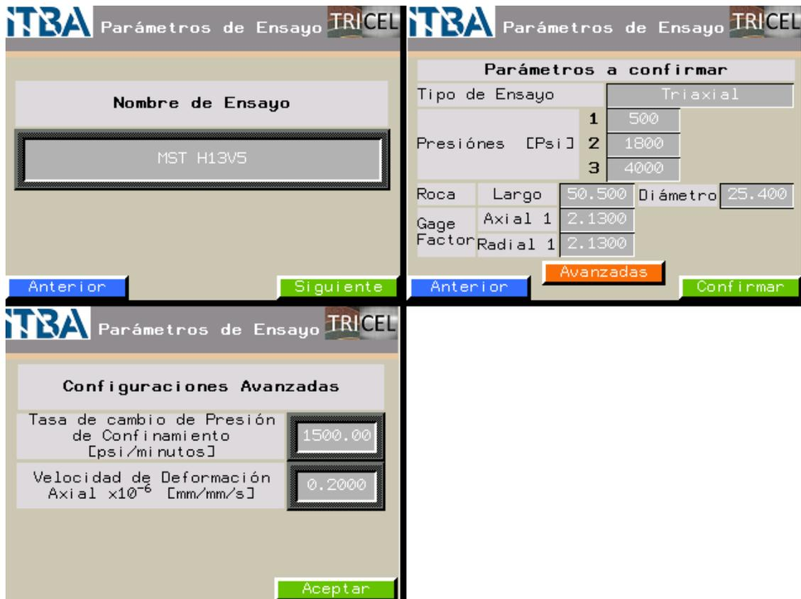
Figura 70. Pantallas para nombrar el ensayo y confirmar los parámetros.
