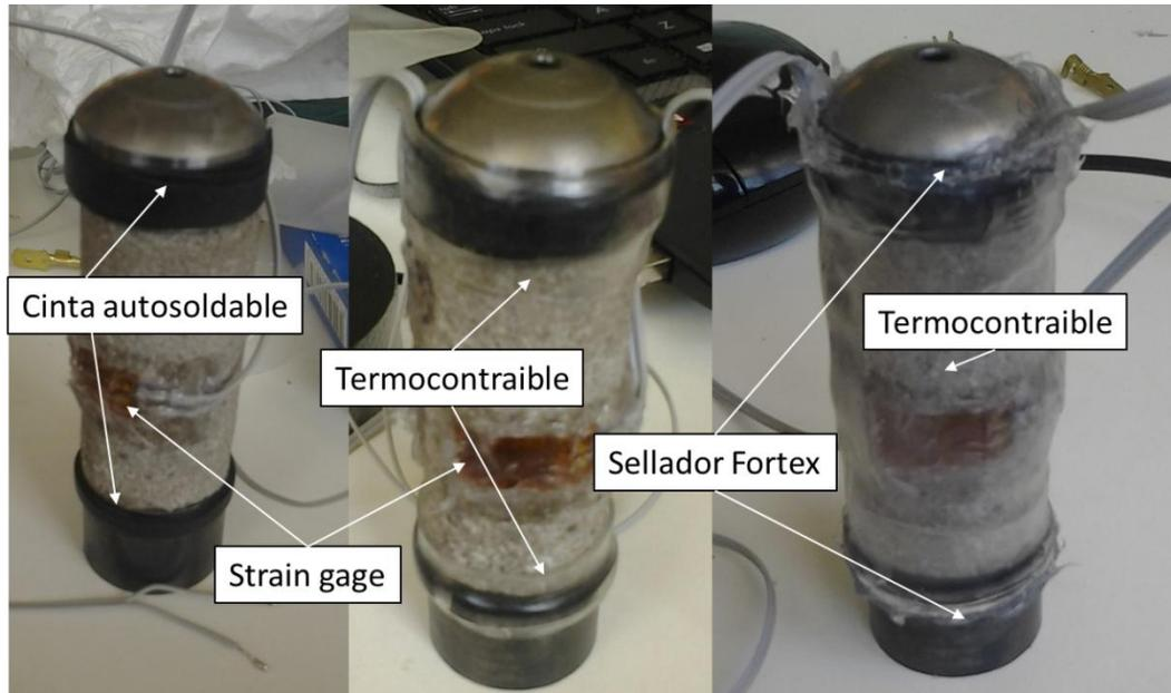
**Figura 105:** Aislamiento de una muestra
