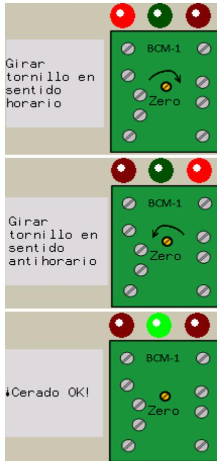
**Figura 48.** Instrucciones para el cerado de los *strain gages*.
