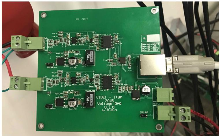
FIGURA A.6: Medición de tensiones de 2 canales
