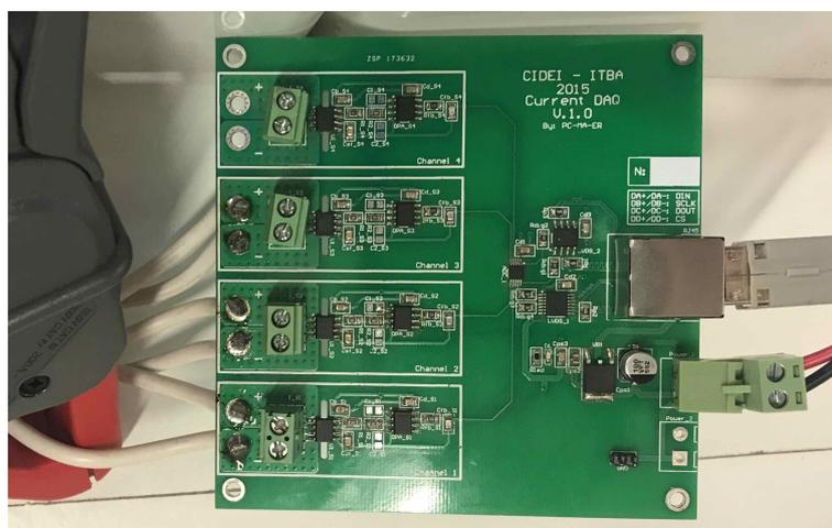
FIGURA A.7: Medición de corrientes de 4 canales
