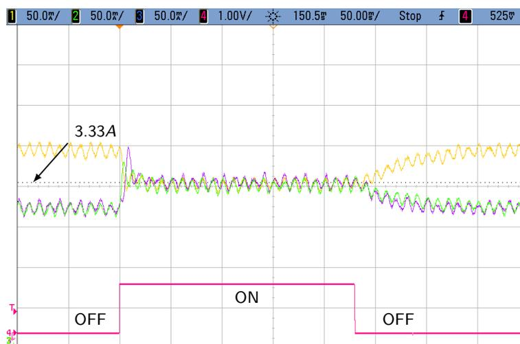
FIGURA 4.10: Escalón en la señal de habilitación del control. Corrientes internas promedio con y sin el control habilitado
