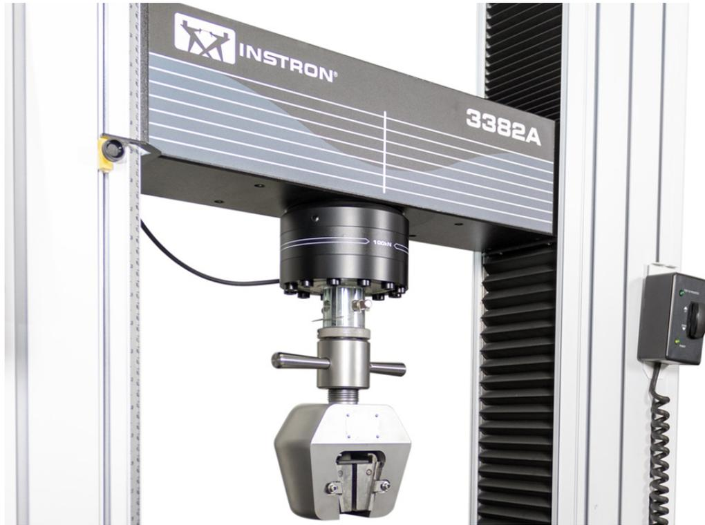
**Figura 3.3.6:** Máquina de ensayos con la cuál se llevó acabo el ensayo de compresión. Marca: Instron. Modelo: 3382A Series Universal Testing Systems.
