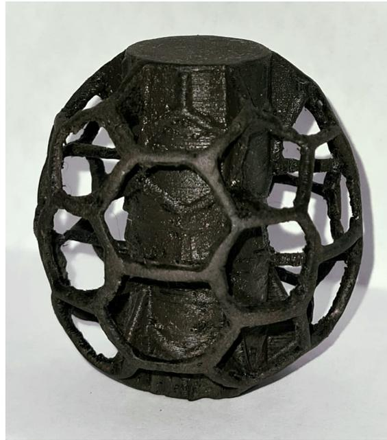
**Figura B2.1:** Diseño de implante final impreso en 3D con PLA.
