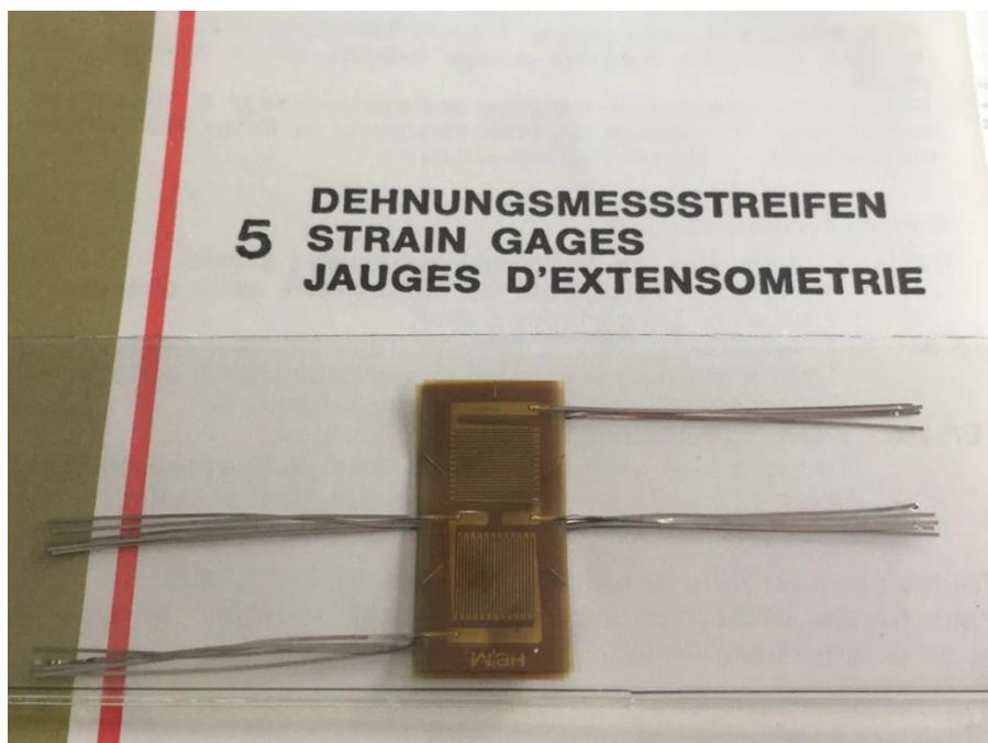
**Figura 3.2.2:** Galgas extensiométricas adquiridas para instrumentar la probeta. Marca HBM Mod. 6/120 XY 11 de  $120 \Omega \pm 0.2\%$ ,  $G_f = 2.03$  y  $\alpha = 11,5 \times 10^{-6} \text{ } ^\circ\text{C}^{-1}$ .
