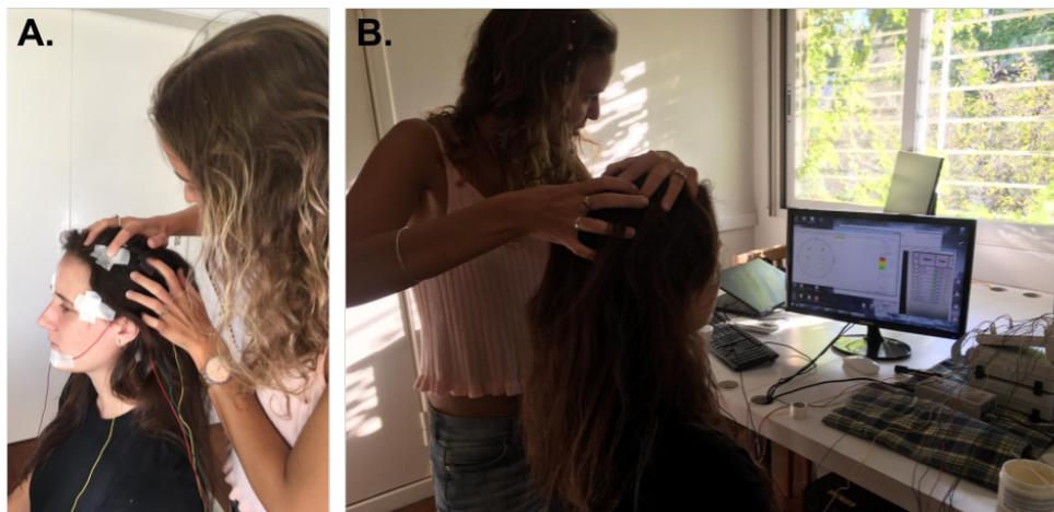
**Figura 2.12:** Colocación de electrodos. **A** Colocación de los 13 electrodos en las posiciones respectivas según el Sistema Internacional 10-20. **B** Verificación de la impedancia luego de la colocación de electrodos.
