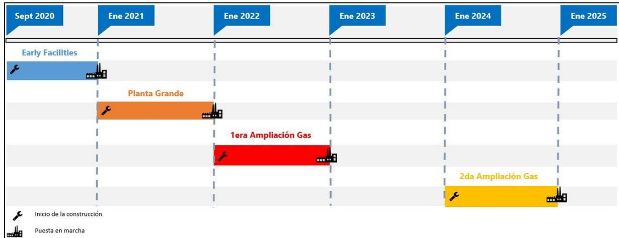
**Ilustración 25:** Cronograma de construcción de las Instalaciones de Superficie. Se usa como ejemplo el escenario de caudal límite 1.000 m<sup>3</sup>/d.
