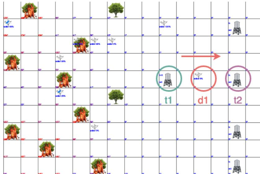
Figura 5.5: Autoorganización de cargas: En la simulación, que se ve en la figura, el enjambre elige los tanques con un criterio de conveniencia, en base a una relación entre distancia y disponibilidad. El drone d1, que se traslada desde los fuegos de la izquierda, se dirige al tanque t2 porque tiene disponibilidad en comparación al tanque t1, que está más cerca en su trayecto pero está ocupado cargando un drone. El drone d1 decidió que para ese momento el tanque t2 era más conveniente que el t1.
