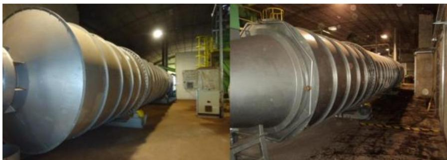
Figura 24. Secador rotatorio Lippel, modelo SRL 10000
