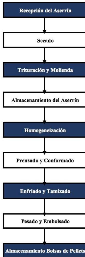
Diagrama 1. Diagrama de bloques del proceso
