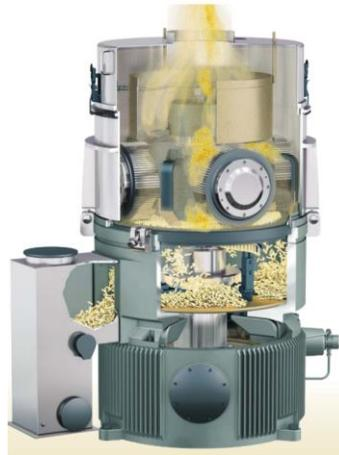
Figura 28. Prensa de pellets Kahl, esquema de funcionamiento interno
