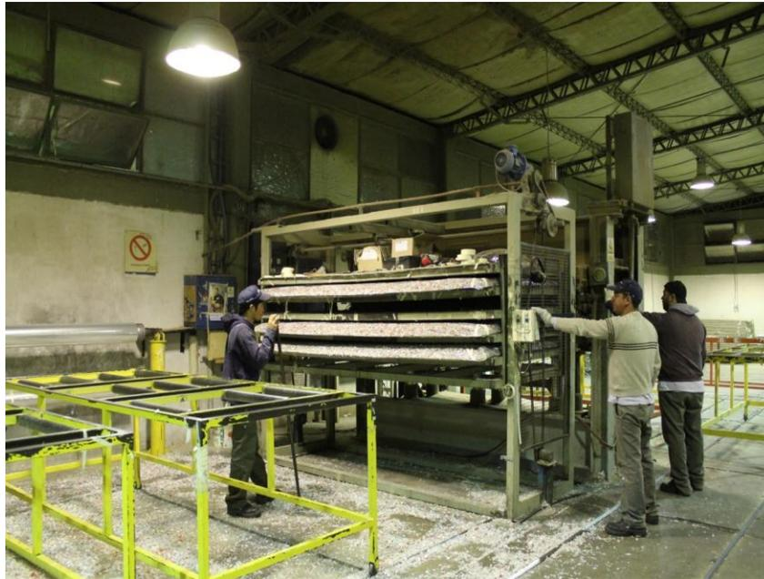
**Ilustración 43. Operarios cargando la prensa. Foto tomada el día 28.07.2016**
