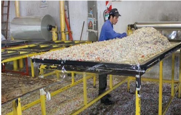
**Ilustración 18. Armado del colchón (Mesa de trabajo 3)**
