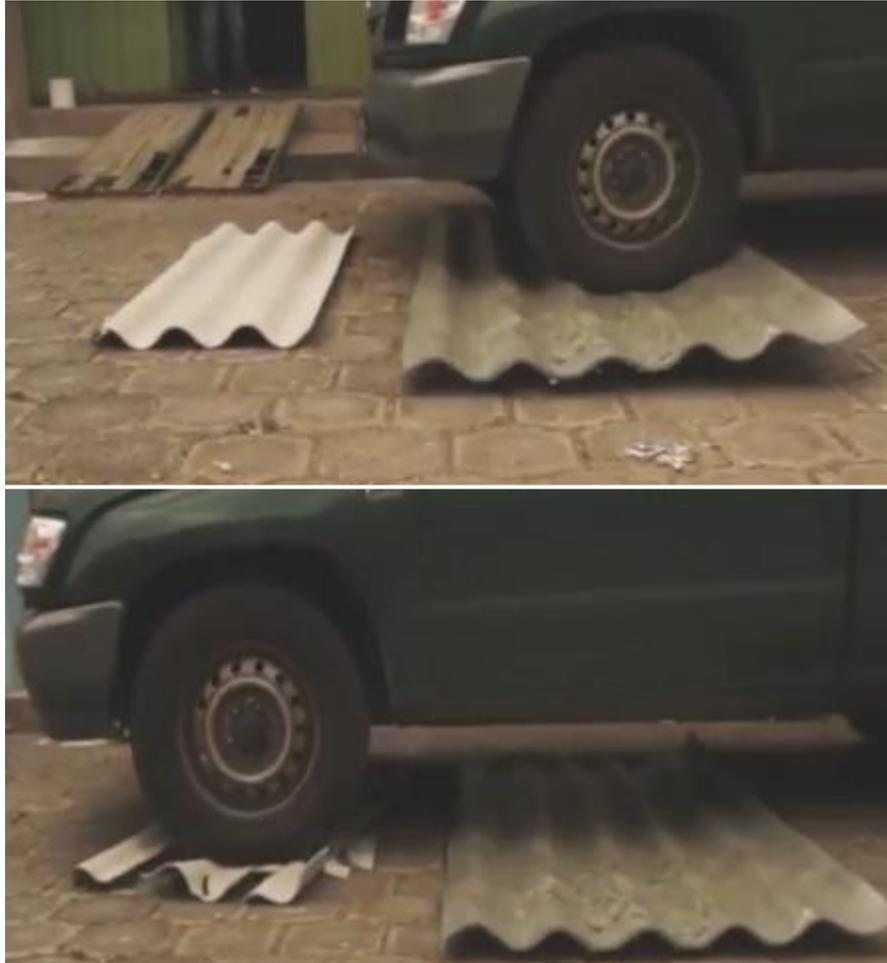
**Ilustración 5. Prueba de la resistencia de la chapa Ecotech**
