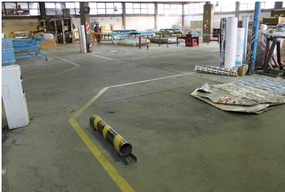
**Ilustración 63. Demarcación en el piso de las áreas de máquinas y pasillos para el autoelevador**
