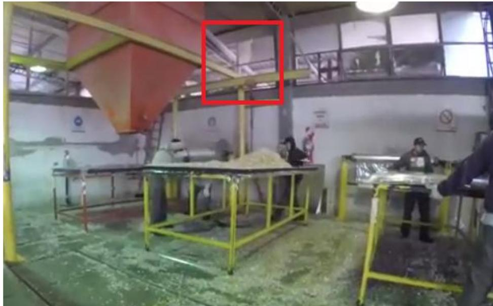
**Ilustración 14. Tubo de PVC ingresando a la tolva (señalización con rojo). Foto extraída de vídeo grabado el día 28.07.2016**
