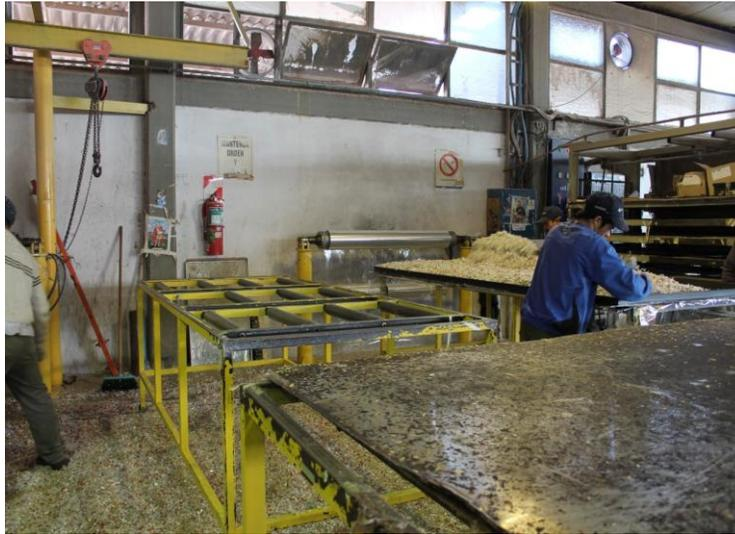
Ilustración 16. Se pueden apreciar las mesas que se mueven sobre rieles y se encuentran entre la mesa con balanza y el elevador.
