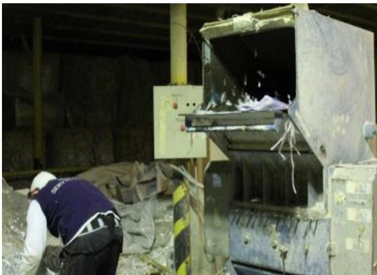
**Ilustración 12. Operario ingresando materia prima a un molino**
