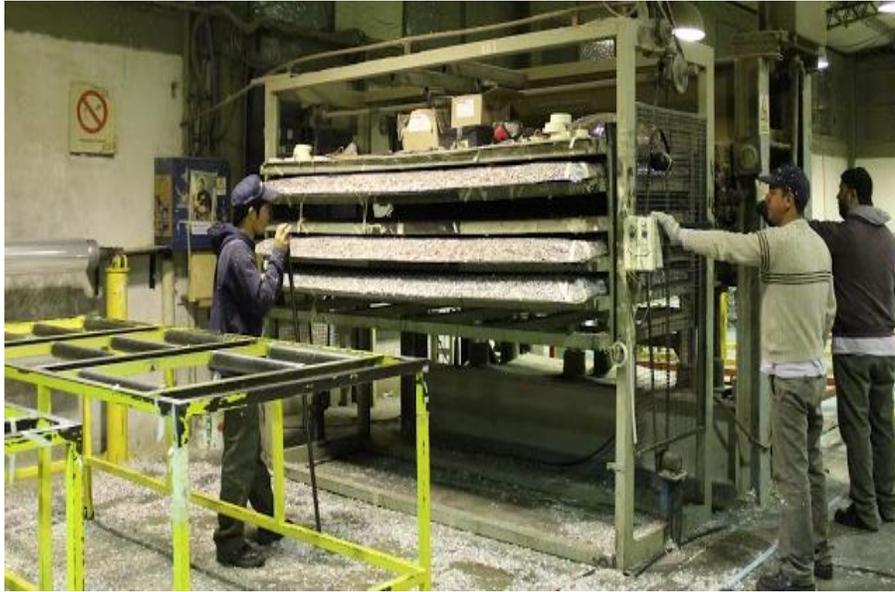
**Ilustración 20. Operarios posicionando el elevador a la altura de los platos de la prensa**
