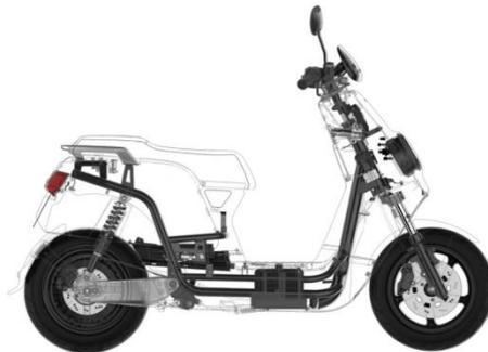
Figura 19: estructura interna del scooter NIU
