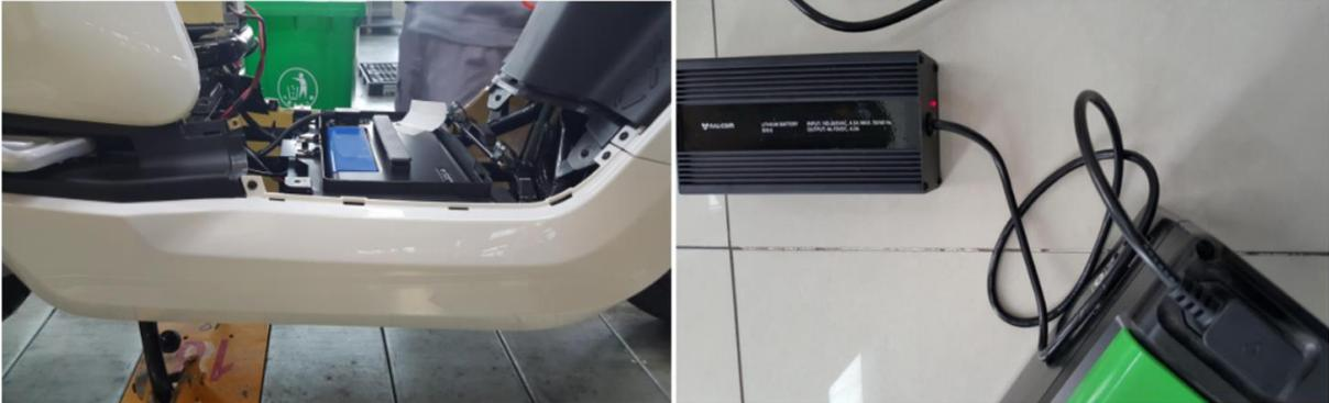
Figura 18: instalación y carga de la batería
