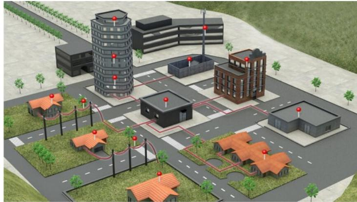
Figura No 1. 38: Especificaciones de Diseño para una red FTTh<sup>10</sup>
