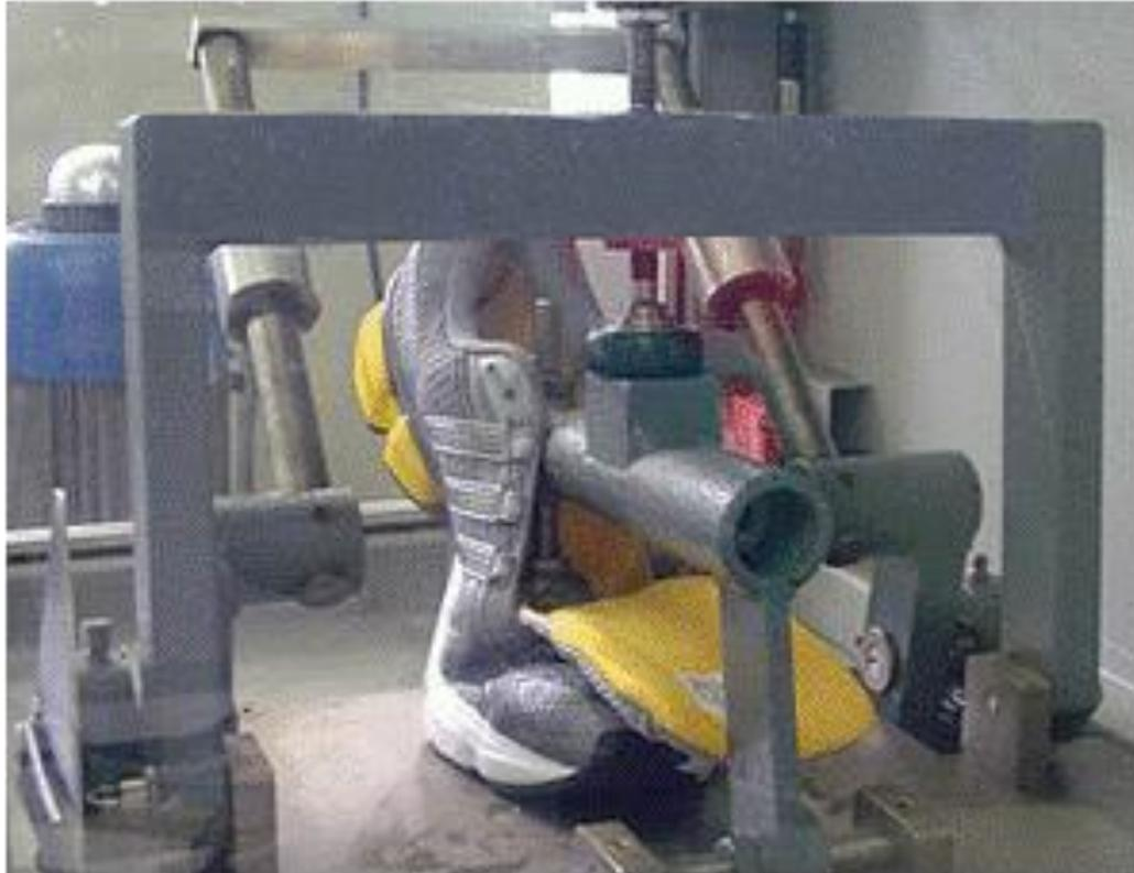
**Fig. 5-1. Ensayo de flexión de calzado completo**
