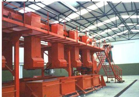
hasta la otra. De forma manual, los empleados encargados de la separación seleccionan los residuos y los introducen en los respectivos recipientes. En primer término seleccionan el papel y cartón, luego las botellas de plástico y por último todo el material metálico es atraído por un gran imán. Finalmente, la cinta transportadora en operación vuelca al final de la misma, en un contenedor especialmente colocado a tal fin, solamente la fracción orgánica de los residuos.
