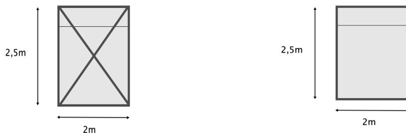
Ilustración 11. Panel estructural (izq) y no estructural (der) simple
