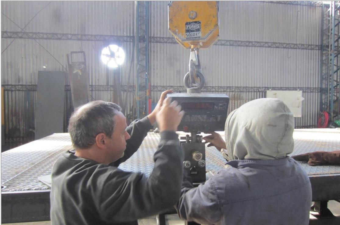
**Imagen 3. Gancho, balanza y mecanismo de agarre unidos al semirremolque**
