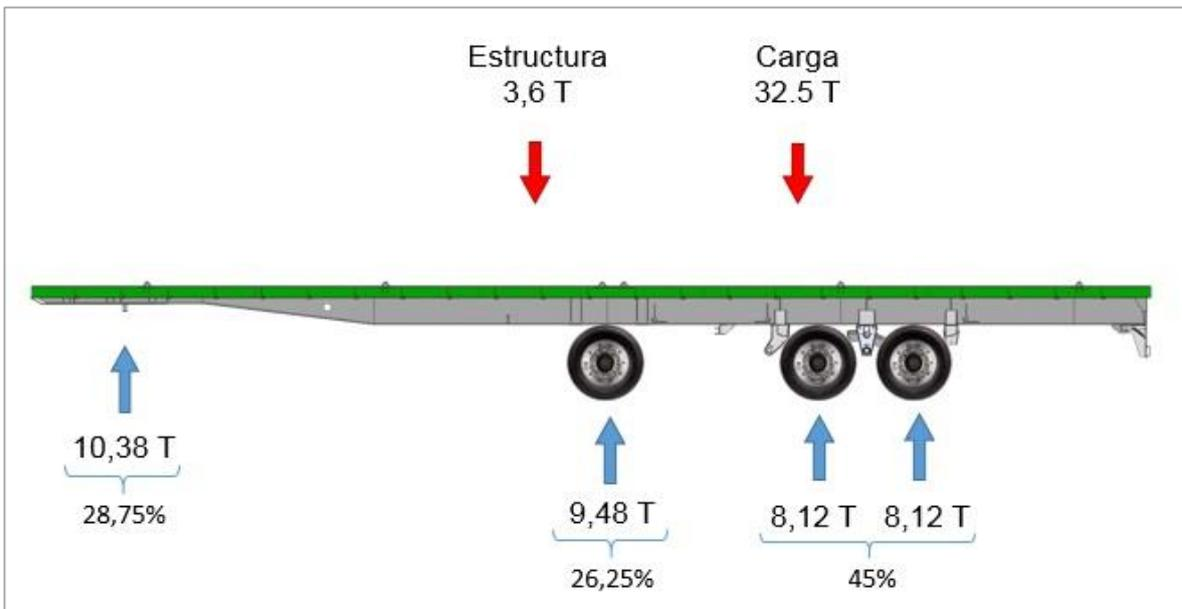
Figura 40. Distribución de cargas con peso de la estructura (3 ejes)
