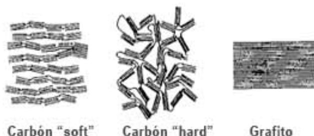
Figura 2.6.31. Estructura interna de los distintos tipos de Carbón
