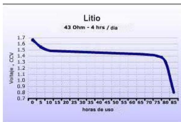
Figura 2.2.6. Gráfico Voltaje-Horas de uso (Pila de Litio)
