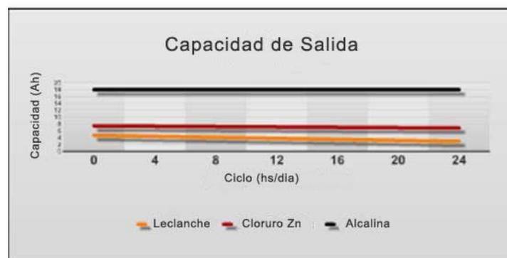
Figura 2.6.8. Capacidad de una Pila Alcalina
