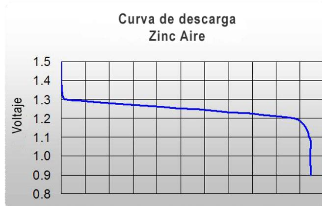
Figura 2.6.18. Curva de descarga Pila de Zinc Aire
