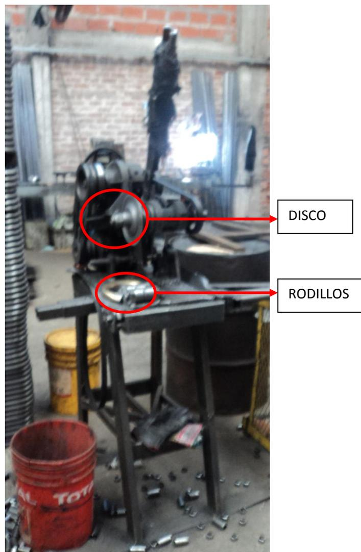
Figura II.1. Cortadora por fricción
