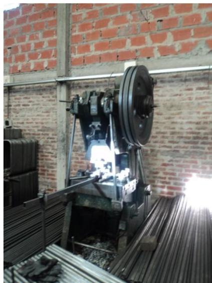
Figura II.9. Balancín 40Tn para hacer la manito
