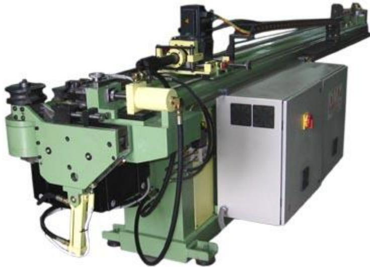
Figura II.7. Dobladora CNC Modelo DTZL-40 DMZ
