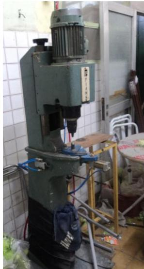
Figura III.8. Remachadora Orbital
