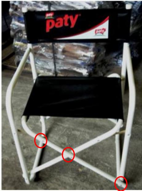
Figura II.12. Perforaciones frontales de la U del SDCR
