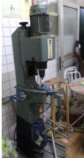
Figura II.19. Remachadora Orbital FIAMH
