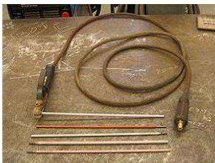
Figura II.10. Soldadura por arco manual c/electrodos revestidos
