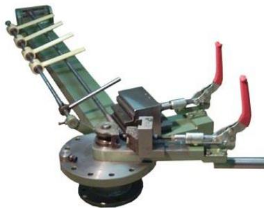
Figura II.3. Dobladora manual Modelo DT3 DMZ
