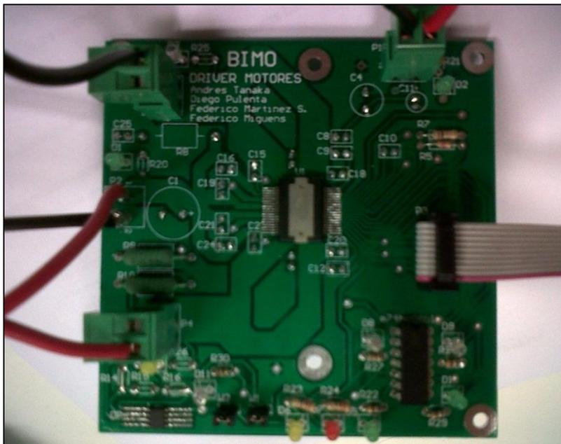
**Fig. 4-23:** Placa de los drivers de los motores con componentes soldados (top layer)
