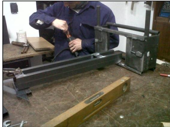
**Fig. 4-14:** Estructura central recién soldada
