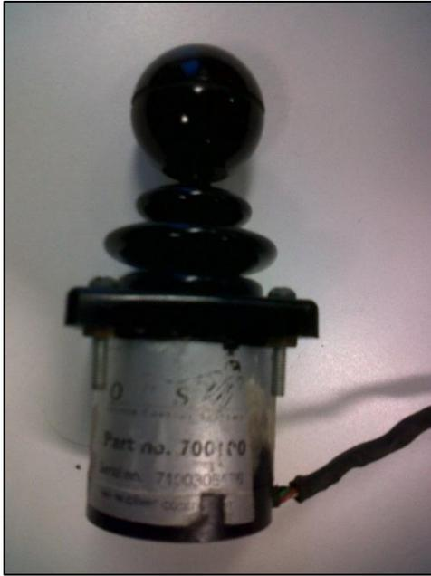
**Fig. 3-49:** Joystick de control de silla de ruedas Oliver proporcionado por la cátedra.
