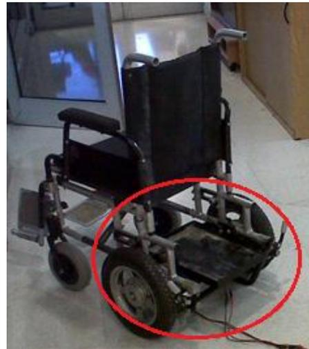
**Fig. 4-9:** Silla de ruedas original con el tren delantero
