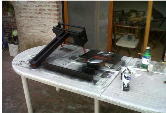
**Fig. 4-13:** Tren delantero en proceso de pintado
