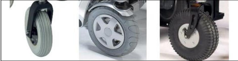
**Fig. 3-24:** Ruedas delanteras de distintos tamaños y materiales.
