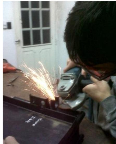
**Fig. 4-10:** Eliminación de partes indeseadas
