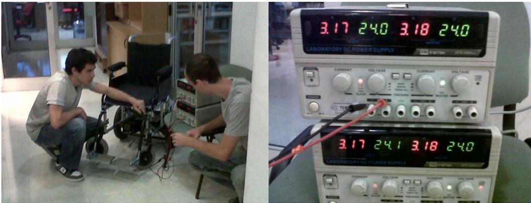
**Fig. 3-36:** Ensayo de consumo de corriente de los motores.
