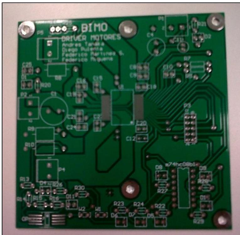
**Fig. 4-21:** Placa de los drivers de los motores (top layer)
