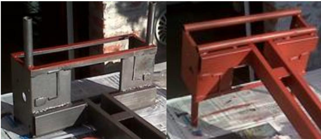
**Fig. 4-12** Tren delantero luego del proceso de arenado (izq) y con la primera capa de antioxidante (der)
