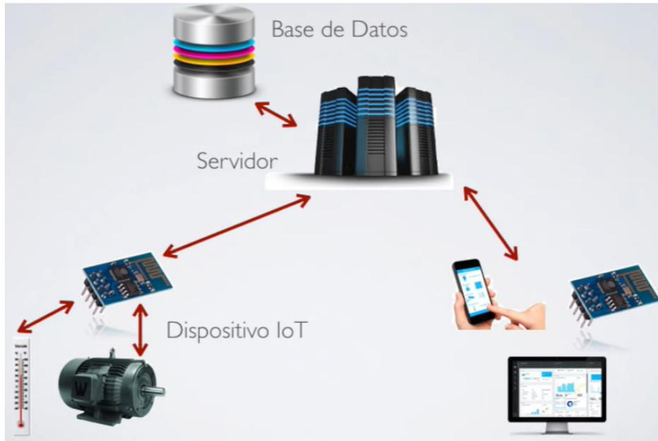
Figura 59: Esquema de comunicación general del prototipo. El medidor es el dispositivo IoT.
