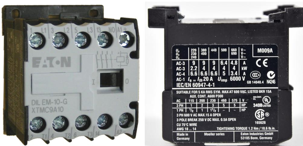
Figura 51: Contactor DIL EEM-10-G de Moeller empleado en el prototipo. De izquierda a derecha los contactos son: los tres interruptores principales, el auxiliar y la bobina.
