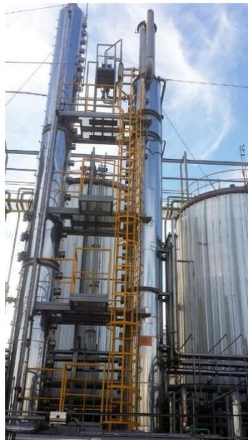
Figura 2.28. Torre de destilación y enfriamiento.
