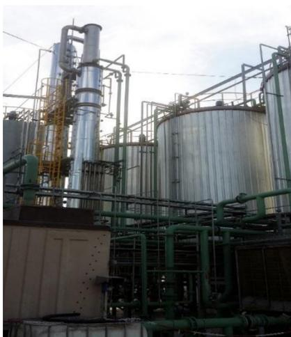
Figura 2.27. Tanques de fermentación, torre de destilación y enfriamiento
