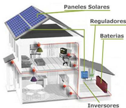
Fig.2.11. Esquema Sistema Solar Fotovoltaico Autónomo
