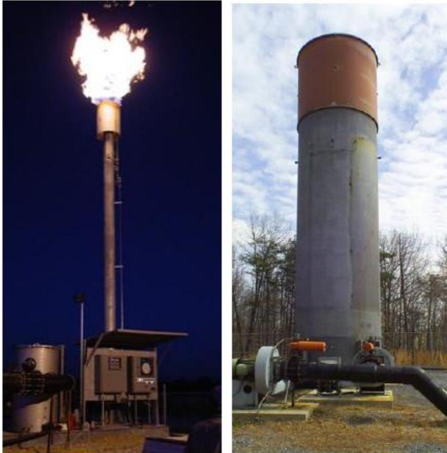
*Figura 2.4.12.1. A la izquierda antorcha abierta y a la derecha antorcha cerrada (fuente: EPA).*
