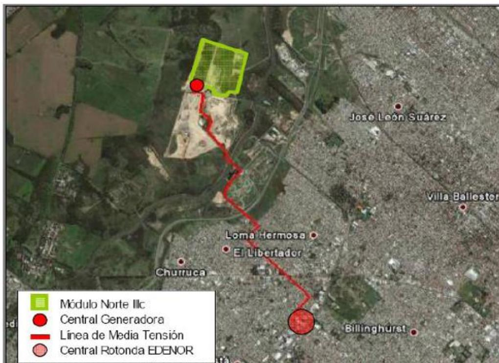
Figura 2.4.11.2. Trazado del electroducto hasta subestación Rotonda, propiedad de EDENOR.
