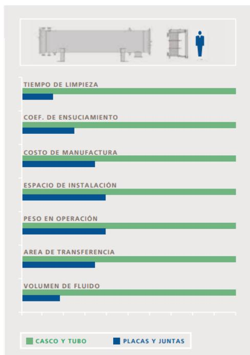
Figura 2.4.3.1. Comparación entre intercambiador de placas y casco y tubo. Fuente: Arax, (2019).
