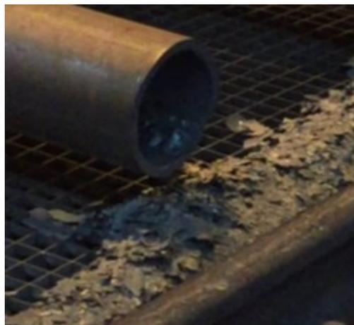
Figura 10: Laminillo o cascarilla de laminación.
