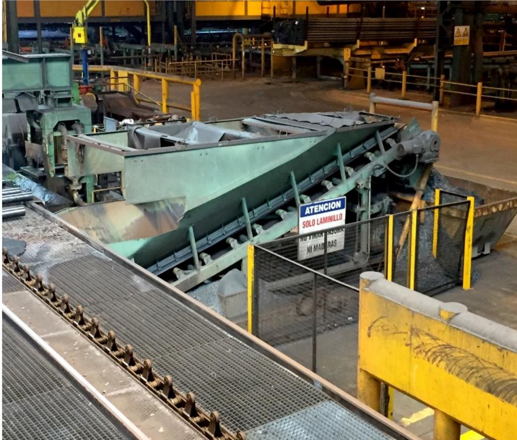
Figura 13: Fotografía de la cinta recolectora rodante "Bardon Oliver".
