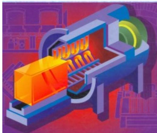
Figura 5: Horno de resistencia típico.
