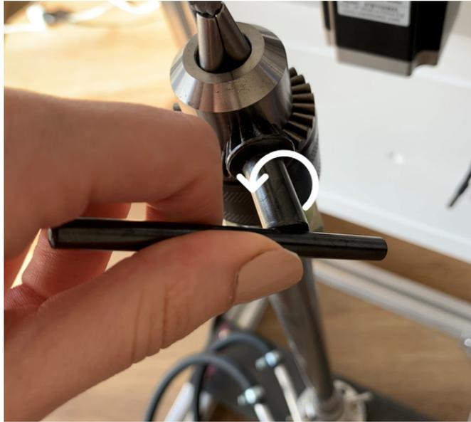
**Figura 8.10** Ajuste manual de la mordaza para una correcta sujeción de la muestra a ensayar.
