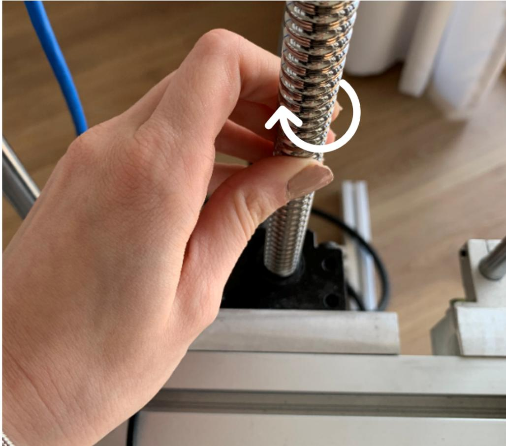
**Figura 8.17** Imagen ilustrativa donde se muestra como se debe girar el tornillo sin fin para regresar la mordaza superior a su punto más alto.
