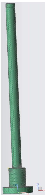
**Figura 4.39** Malla del análisis final de la brida. Análisis de elementos finitos utilizando tetraedros de 10 nodos.
