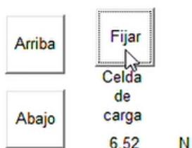
**Figura 8.12** Botón para fijar la celda de carga en cero. El valor mostrado en pantalla será aquel que corresponde al inicio del ensayo para determinar el cero de carga.
