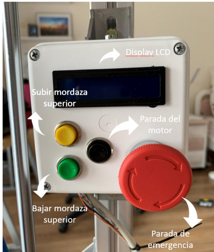
**Figura 5.10** Botonera adherida al frame indicando la función de cada una de sus partes.
