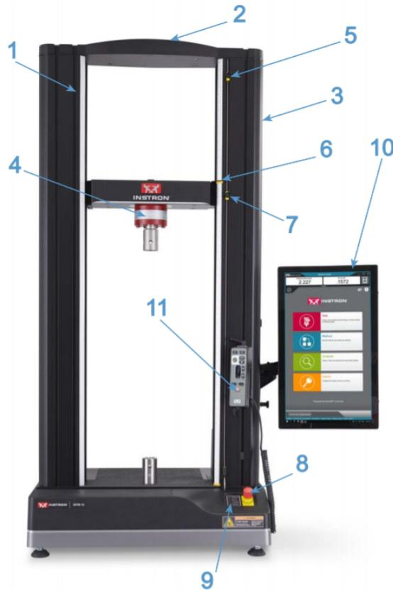
**Figura 2.1** Ejemplo de máquina universal de ensayos Instron modelo 68TM-10 Dual Column Table Model con sus componentes principales detallados en el Cuadro 2.1 [2].
