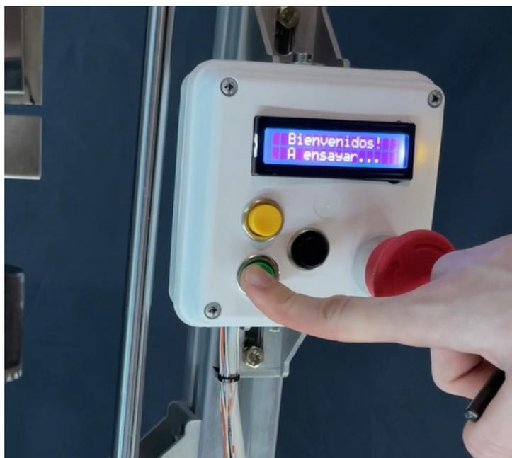
**Figura 8.11** Botonera física para mover la mordaza superior hacia arriba de modo que quede tirante la muestra a ensayar.
