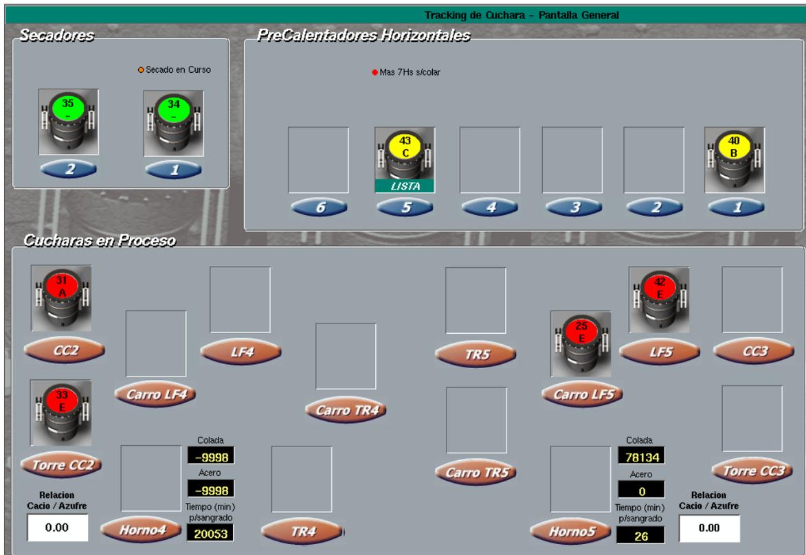
Figura 14: Captura de pantalla de la aplicación de Phindows usada actualmente para rastrear las cucharas
