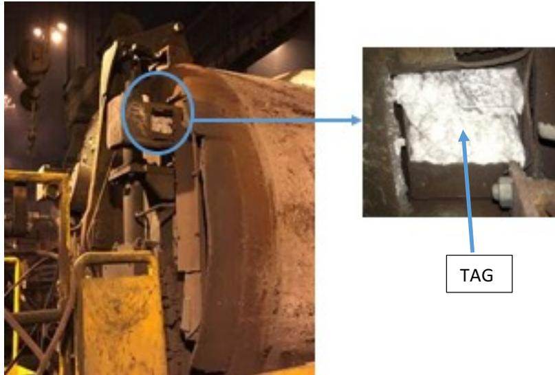
Figura 20: Tag dentro de empaquetamiento de manta térmica en pata de cuchara
