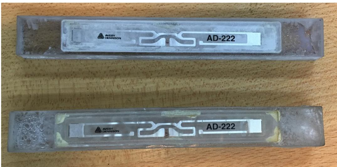
Figura 21: Comparación tag nuevo con tag luego de 14 coladas
