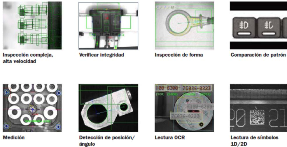
Figura 9: Diferentes formas de utilizar la visión inteligente de las cámaras Microscan [1]
