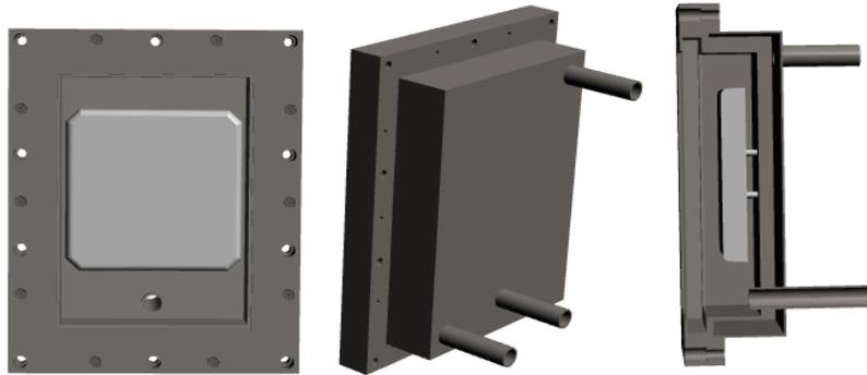
Figura 33: Conjunto antena + protección
