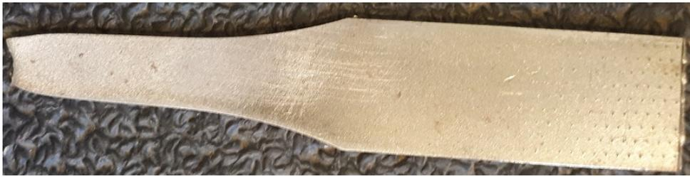
Figura 5.2.2: Probeta rota
