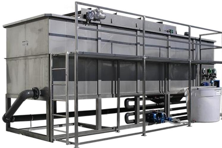
*Figura 15-2.* (Agua Sigma, 2019) Equipo de flotación ACAF SIGMA por aire inducido.
