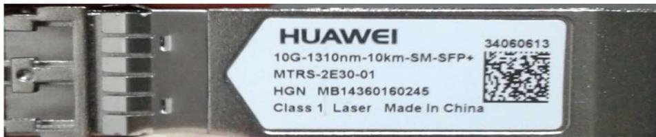
**Figura 33 - Módulo SFP+ de las placas TTX de Huawei**
