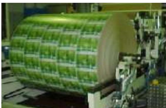
**Figura 3.1.2-2.** Bobina de impresión. Contiene 89.000 envases en 5 bandas.
