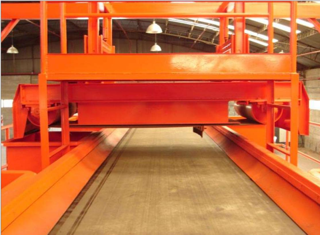
**Figura 14.2.5.a Separador de Ferrosos**
