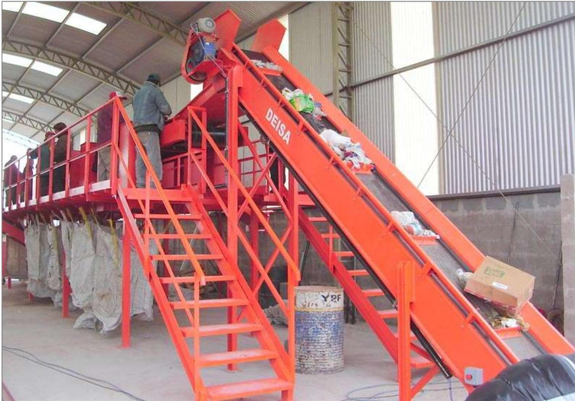
**Figura 14.2.2.a Cinta de elevación**
