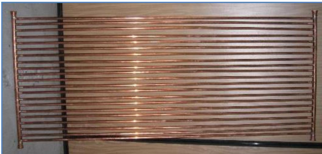
Figura 6 - Disposición de los tubos colectores y calentadores de un colector en proceso de fabricación.
