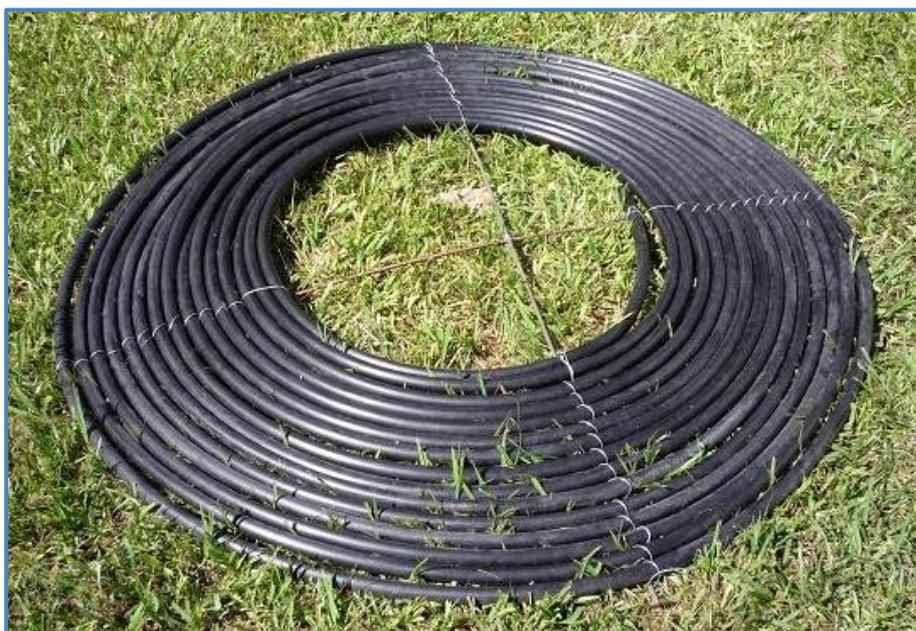
Figura 2 – Manguera de PEAD dispuesta en forma de espiral con entrada y salida únicas.
