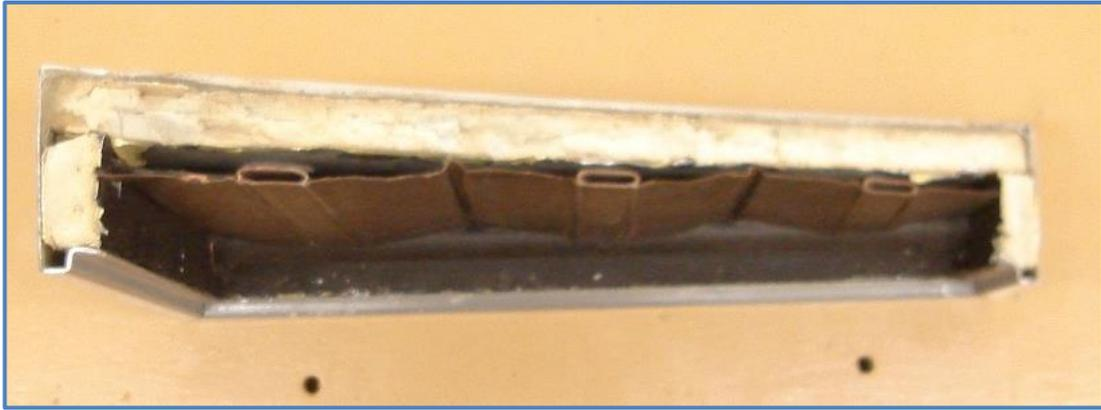
Figura 4 – Detalle de la aislación de espuma de poliuretano en la parte posterior y los laterales del bastidor.
