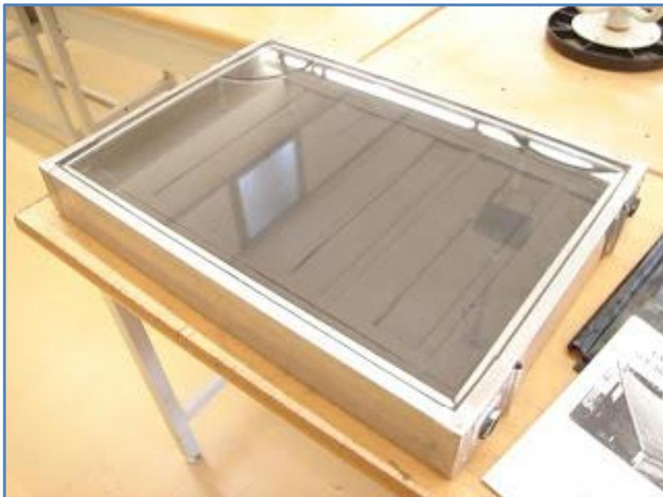
Figura 3 – Bastidor metálico sellado con cubierta de vidrio templado.
