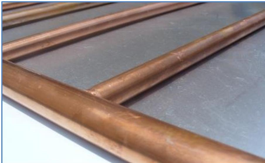
Figura 5 – Detalle de la cubierta trasera reflectante, compuesta por una placa de Aluminio.
