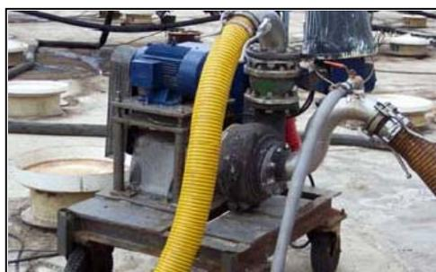
*Figura 2.1.6: Bomba para transportar aceitunas*
