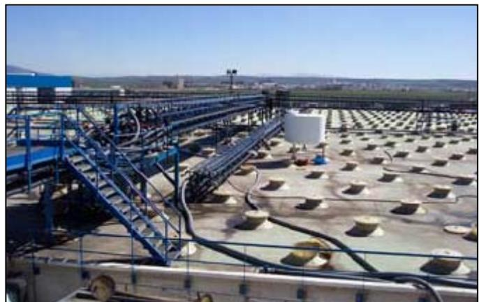
Figura 2.1.3: Tanques fermentadores al aire libre y tuberías para transportar líquidos y aceitunas.
