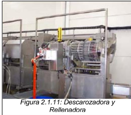
Figura 2.1.11: Descarozadora y Rellenadora
