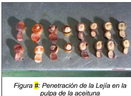
Figura #: Penetración de la Lejía en la pulpa de la aceituna
