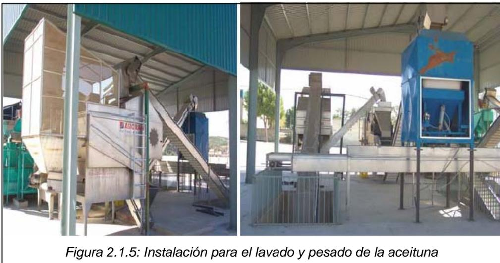
*Figura 2.1.5: Instalación para el lavado y pesado de la aceituna*
