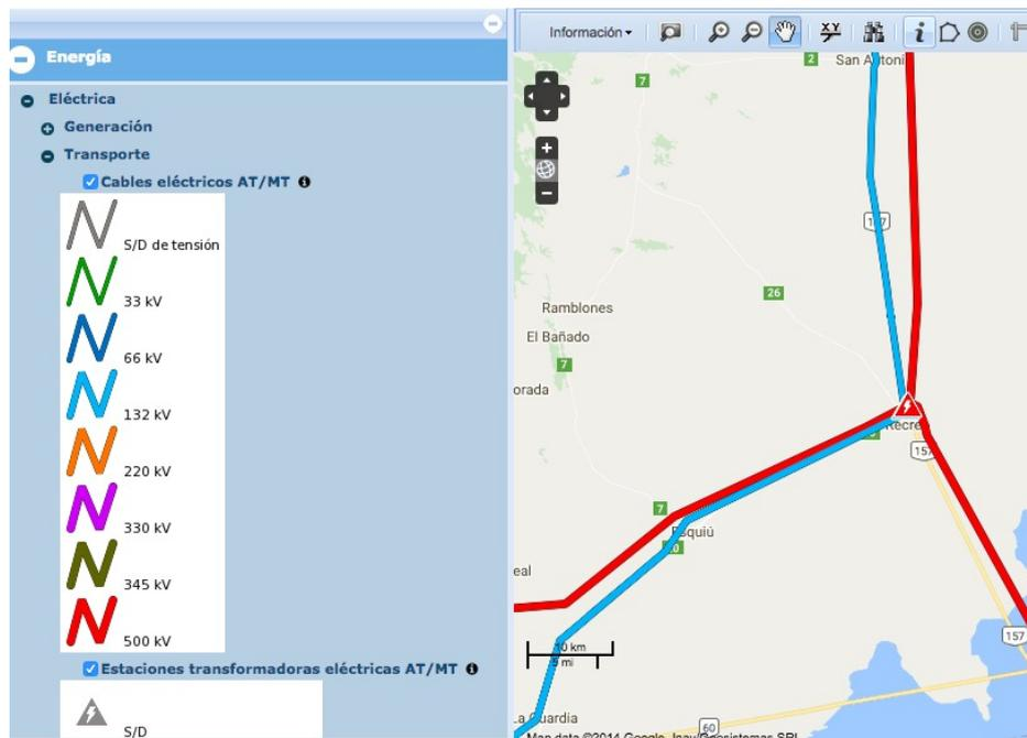
Información geográfica del Ex Ministerio de Energía y Minería sobre distribución en cables eléctricos AT/MT de 500 kV, 132 kV, 33 kV respectivamente:
