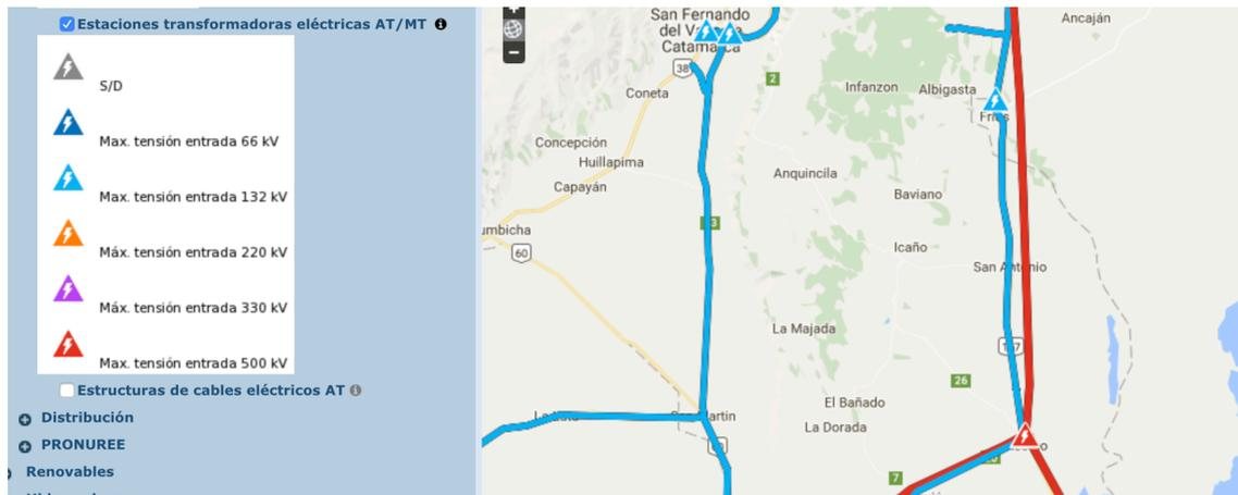
Luego de analizar la Información geográfica del Ex Ministerio de Energía y Minería sobre transporte en cables eléctricos AT/MT de 132 kV y 500 kV respectivamente y Estaciones Transformadoras de 500 kV, 132 kV y 33 kV, identificamos la estación transformadora Frías (Prov. Santiago del Estero) como la candidata para nuestra conexión.
