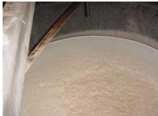
**Figura 2.2.3.2: Espuma generada en la fermentación en el washtun.<sup>29</sup>**
