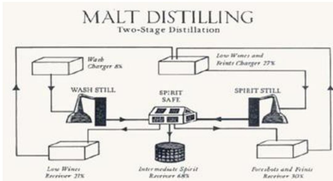
Figura 2.2.4.2: Proceso de doble destilación, tipo batch o Pot Still.<sup>32</sup>
