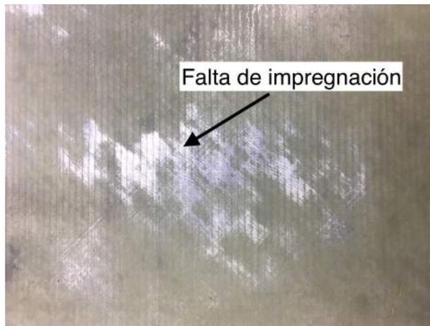
Figura 16: Falta de impregnación en un laminado con nanosílice al 2% en peso
