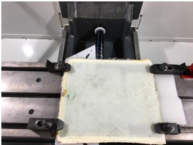
(a) Laminado en fresadora CNC
