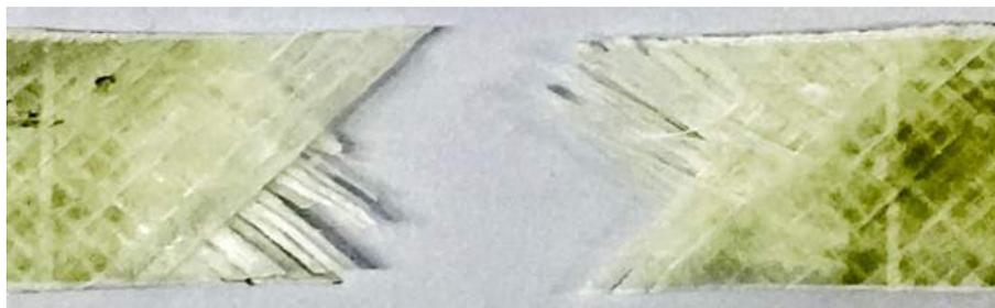
Figura 44: Ruptura por tracción
