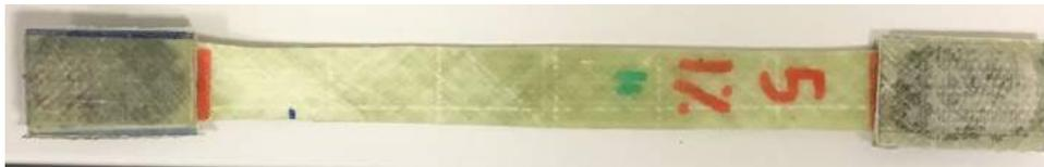
Figura 55: Probeta de PUR (1%ns) a los 1400 ciclos.
