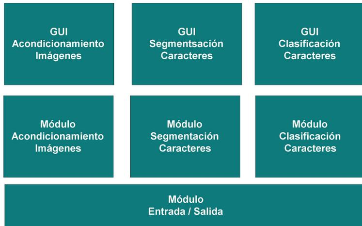
**Diagrama EVS 1 Descomposición en subsistemas**
